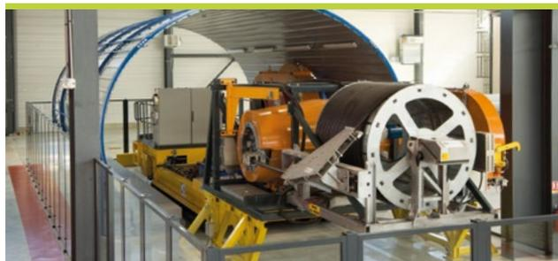
L'Espace technologique présente Cigéo à travers l'exposition de maquettes et de différents robots et prototypes industriels réalisés par l'Andra. L'objectif est de tester et valider les concepts technologiques de ce stockage : conteneur de colis en béton, système de manutention, etc.
