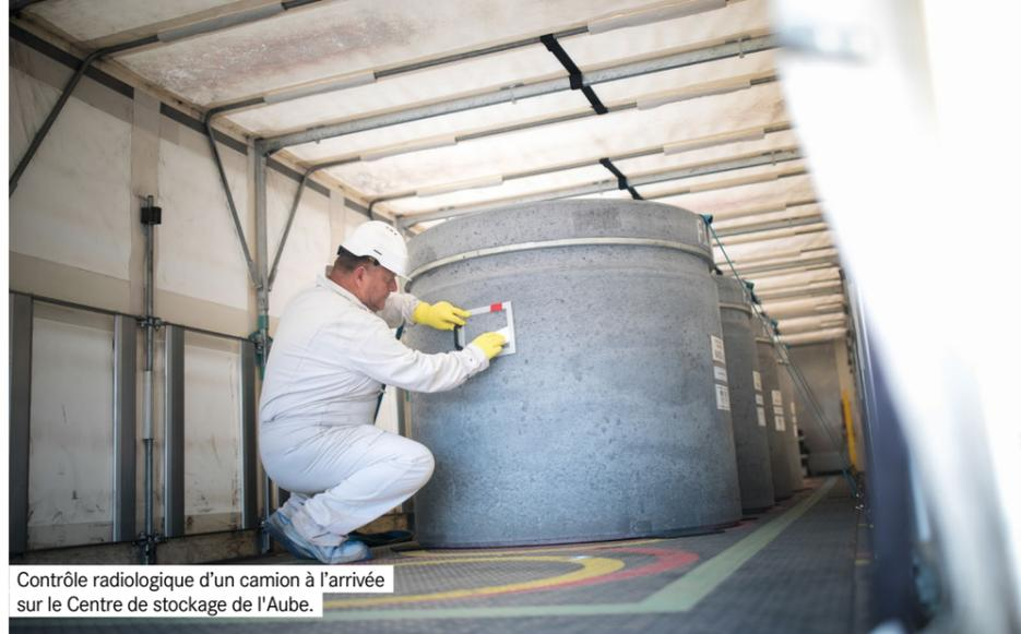
Contrôle radiologique d'un camion à l'arrivée sur le Centre de stockage de l'Aube.
