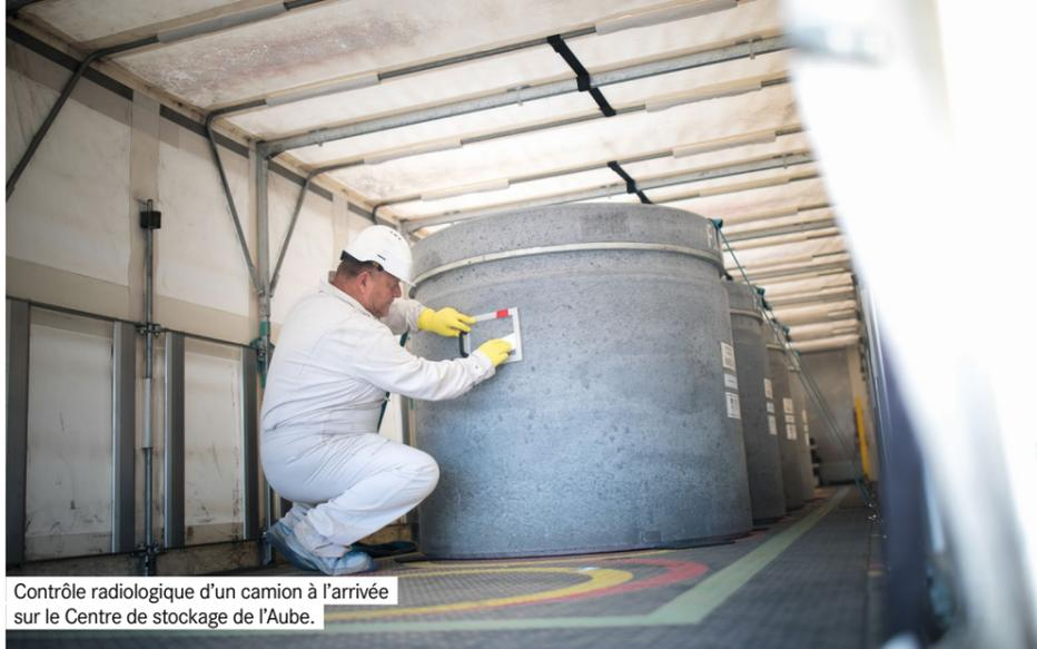
Contrôle radiologique d'un camion à l'arrivée sur le Centre de stockage de l'Aube.
