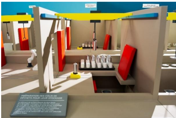
Déchargement des colis de déchets de leur emballage de transport
