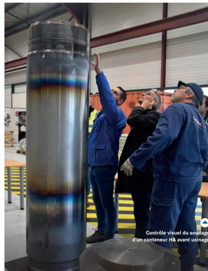
Contrôle visuel du soudage d'un conteneur HA avant usinage
