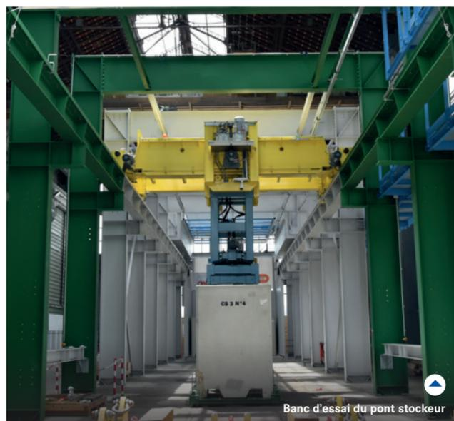
Banc d'essai du pont stockeur
