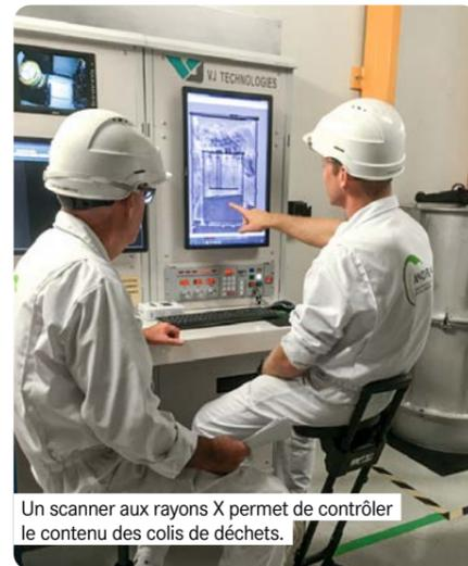
Un scanner aux rayons X permet de contrôler le contenu des colis de déchets.
