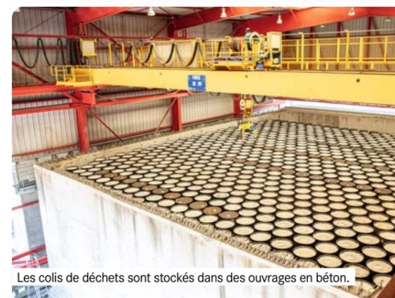
Les colis de déchets sont stockés dans des ouvrages en béton.
