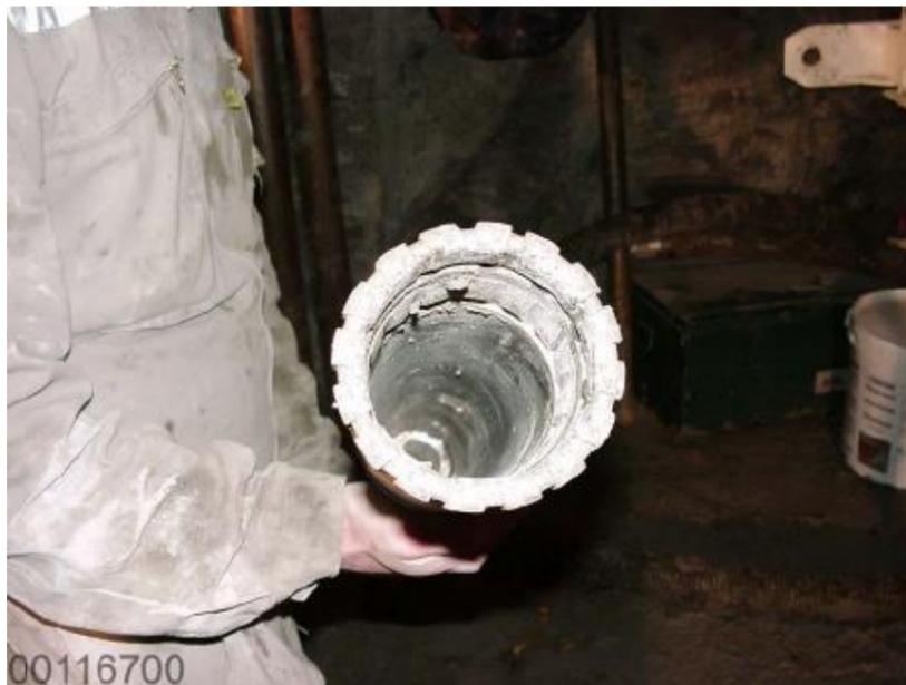
Figure 3-34 Couronne de carottage vissée sur un carottier
