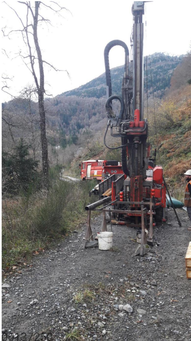
Figure 3-46 Photographie d'un sondage carotté (Source : Egis, projet Pau-Canfranc)
