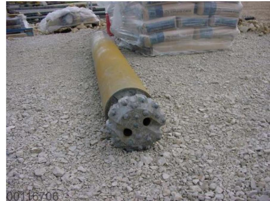
Figure 3-35 Taillant connecté à un marteau fond de trou pour forage à l'air
