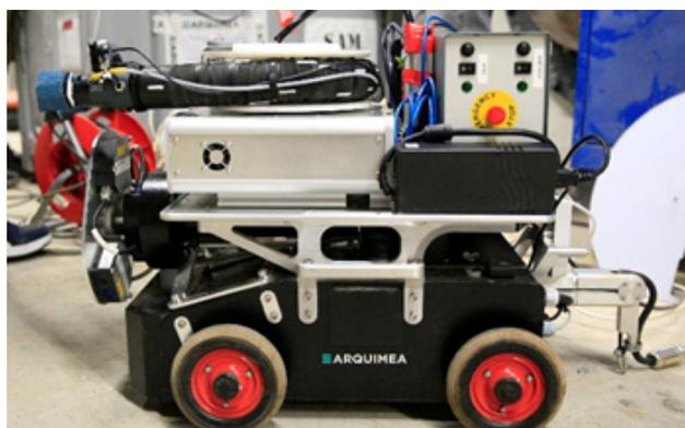
La spécificité des alvéoles HA : (environ 80 cm de diamètre et 80 à 150 m de longueur), a nécessité le développement d'un véhicule d'auscultation, appelé « Sam », adapté à ces dimensions.
