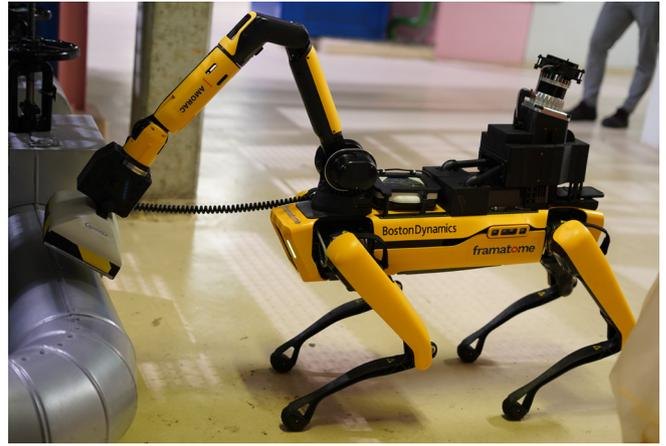
Le robot AMORAC est conçu pour réaliser de façon complètement automatisée des mesures précises dans l'environnement et générer la documentation associée. L'équipementier du nucléaire Framatome a apporté tout son savoir-faire, ajouté des capteurs, des ordinateurs et divers algorithmes sur un robot quadripède afin d'en faire un allier efficace dans l'exploitation des sites industriels critiques.
