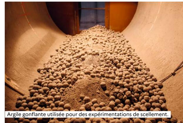
Argile gonflante utilisée pour des expérimentations de scellement.
