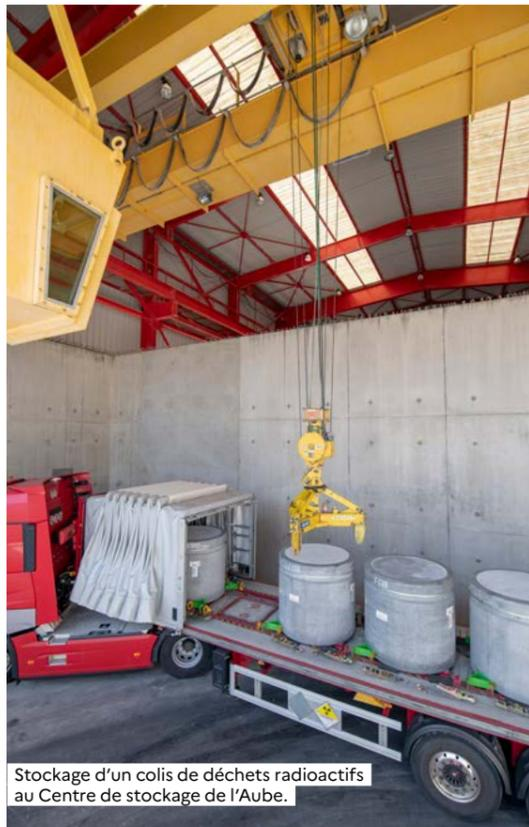
Stockage d'un colis de déchets radioactifs au Centre de stockage de l'Aube.
