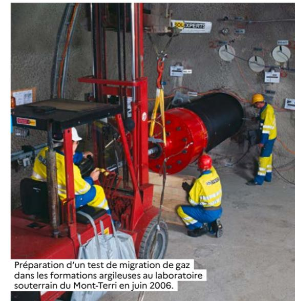
Préparation d'un test de migration de gaz dans les formations argileuses au laboratoire souterrain du Mont-Terri en juin 2006.
