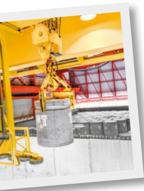
Les colis de déchets sont stockés dans des cases en béton armé de 25 m de côté et 8 m de hauteur.
