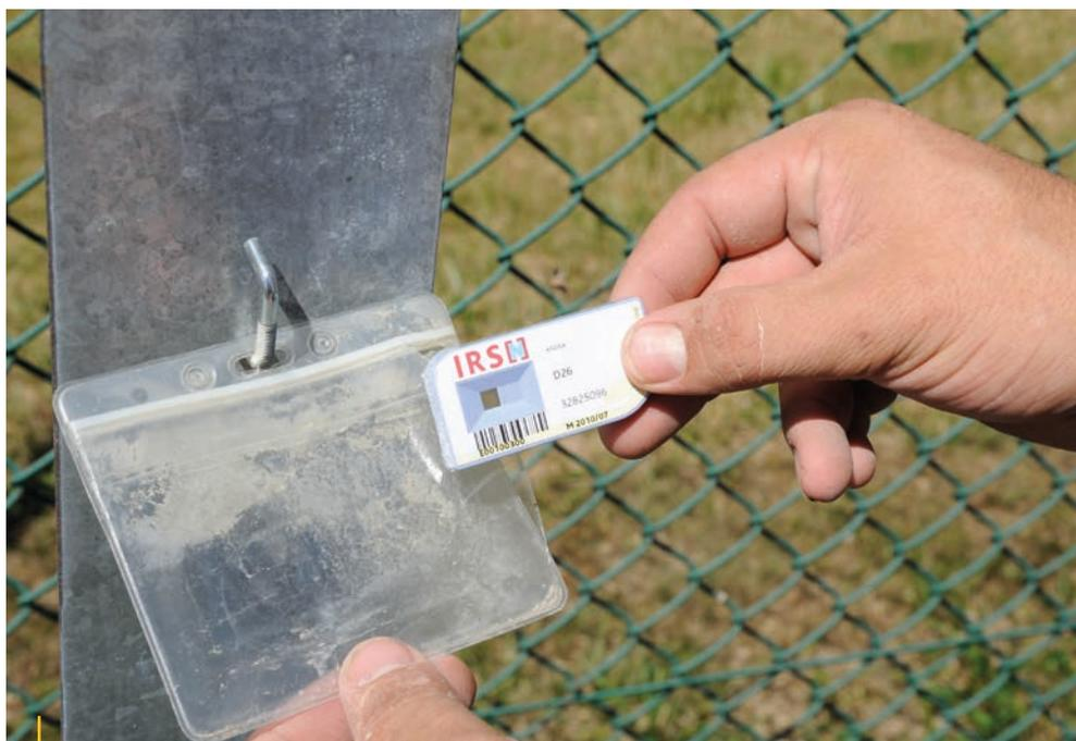
Dosimètre permettant de mesurer le rayonnement ambiant
