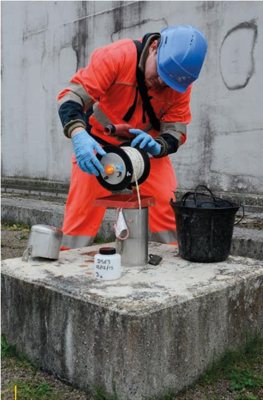
Prélèvement d'eau de la nappe souterraine depuis un piézomètre
