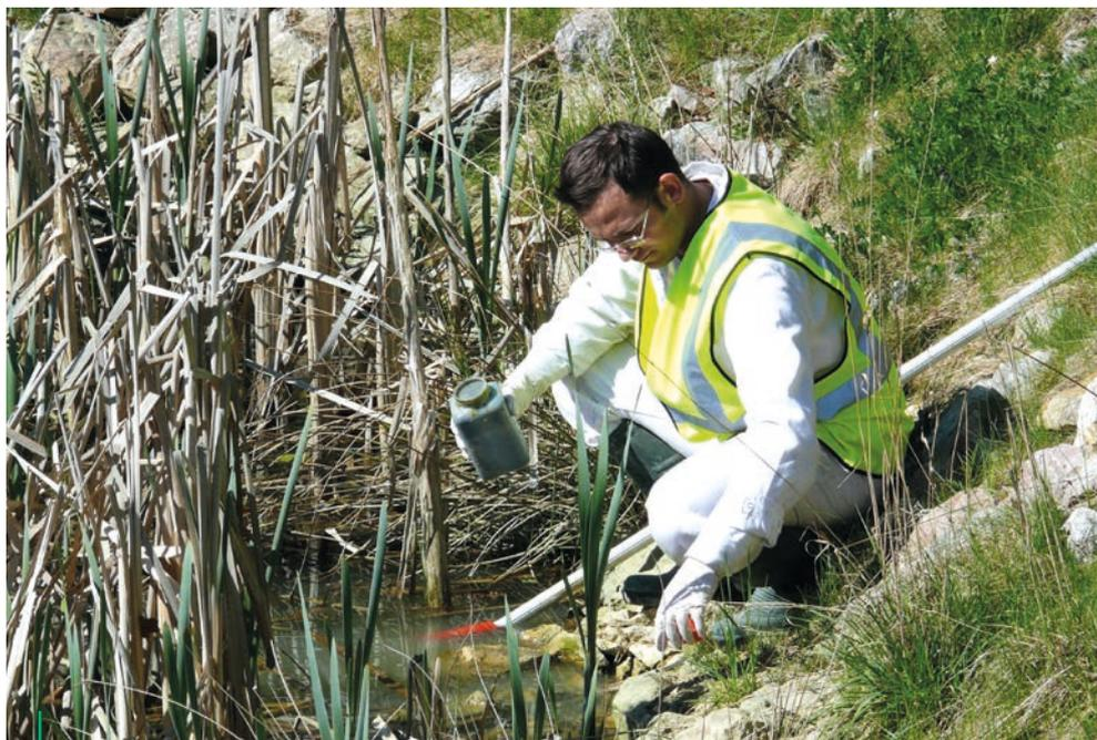
Prélèvement de sédiments pour analyse
