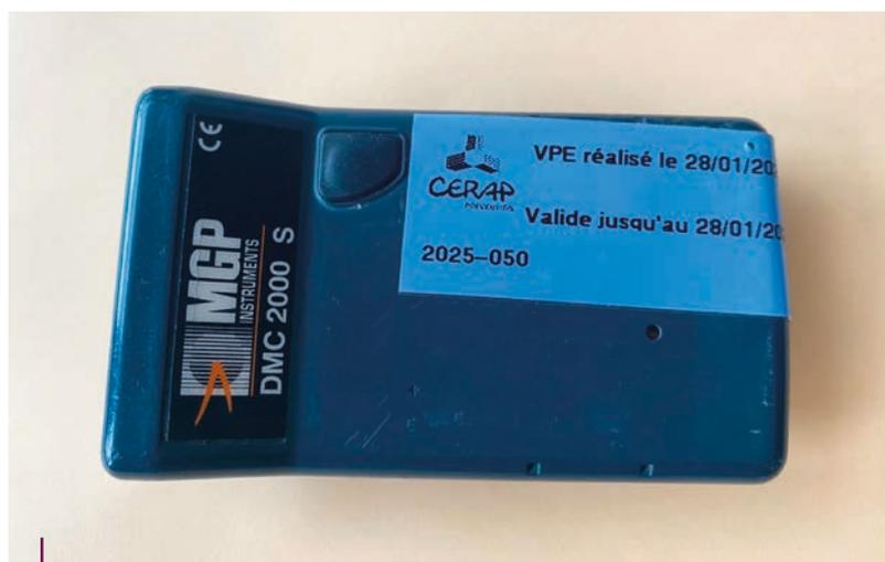
Le dosimètre opérationnel mesure en temps réel l'exposition externe
