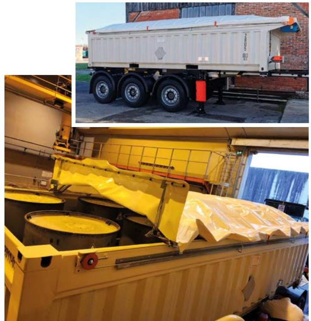
Nouvelle remorque à partir de 2024 pour le déchargement des colis de déchets au CSA permettant de réduire le risque incendie.
