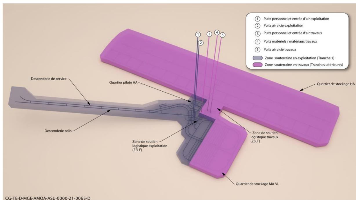
Figure 3-8 *Illustration de principe de séparation des zones souterraines en exploitation et en travaux et liaisons surface-fond associées (dimensions et proportions non représentatives)*
