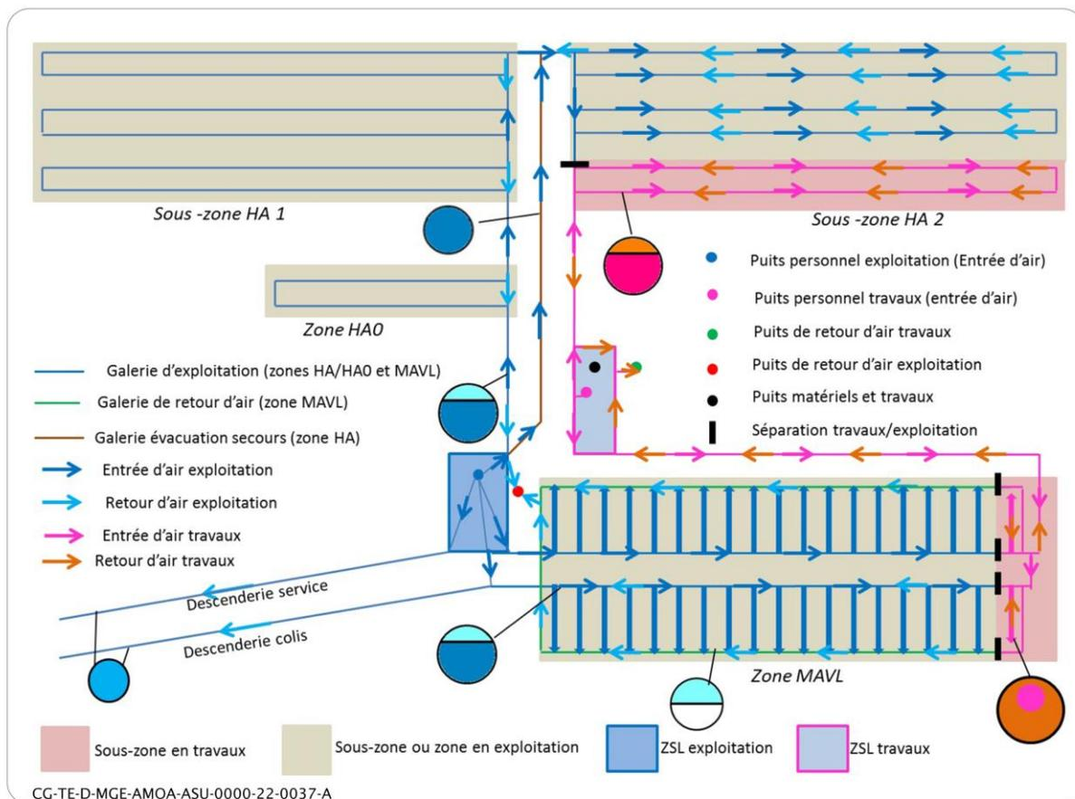
Figure 4-28 Schéma de principe de la ventilation des ouvrages souterrains
