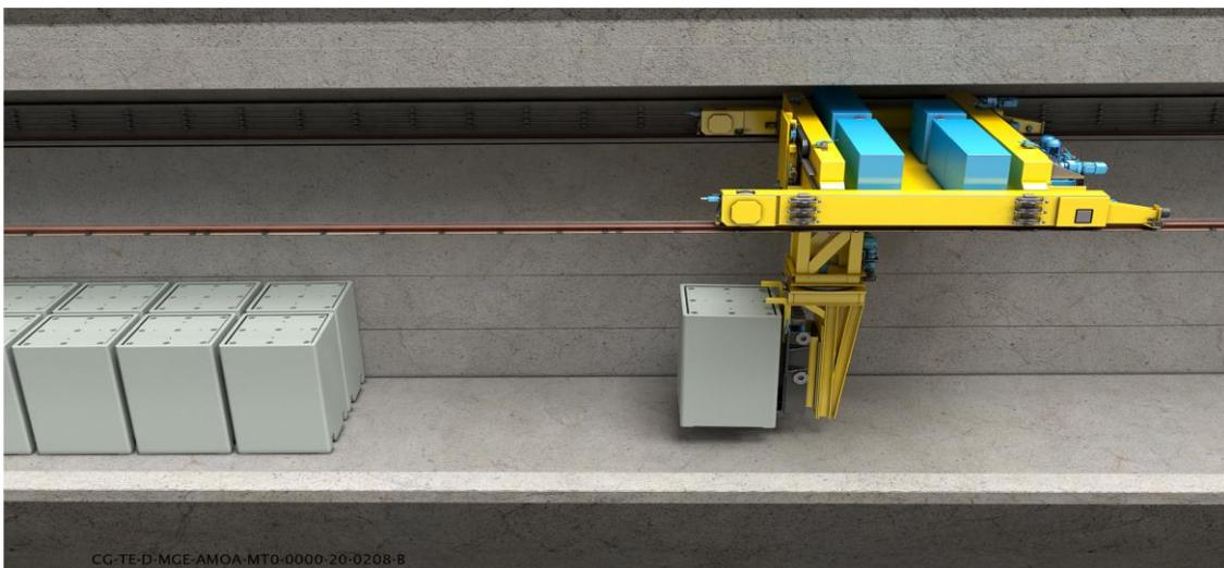
Figure 4-22 *Illustration d'un exemple d'utilisation d'un pont stockeur déplaçant un colis de stockage MA-VL dans la partie utile de l'alvéole*
