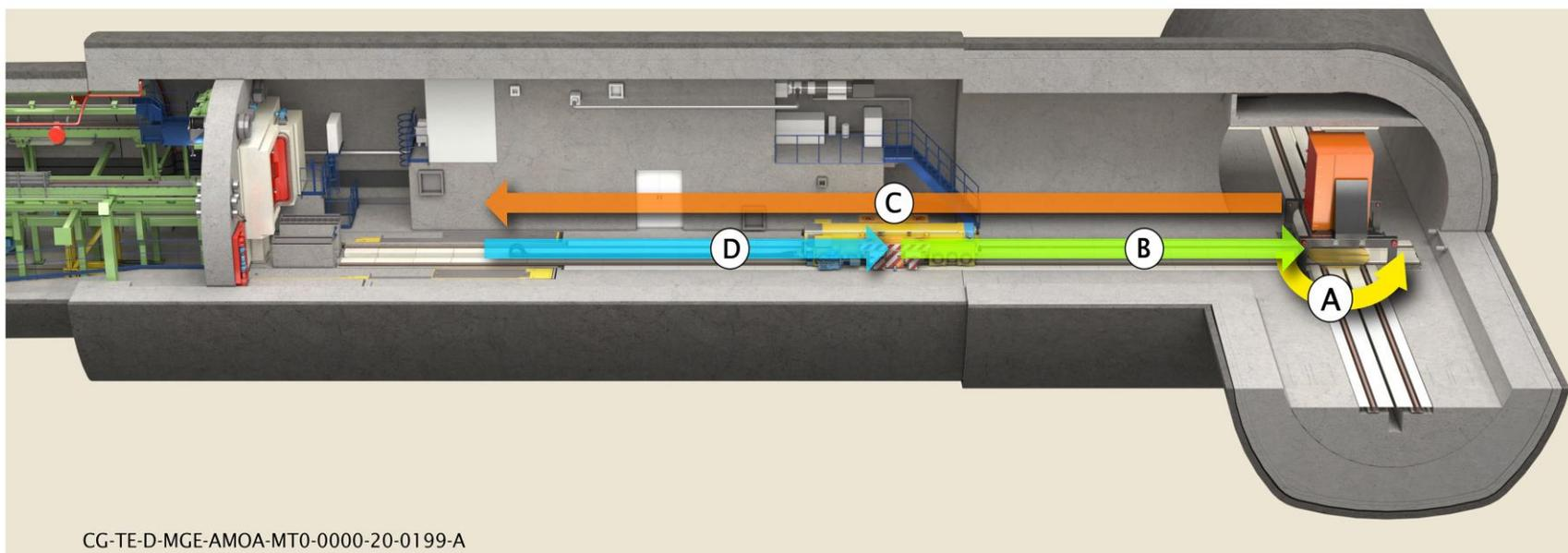
Figure 4-19 Illustration du principe de transfert des hottes en galerie d'accès d'un alvéole de stockage MA-VL
