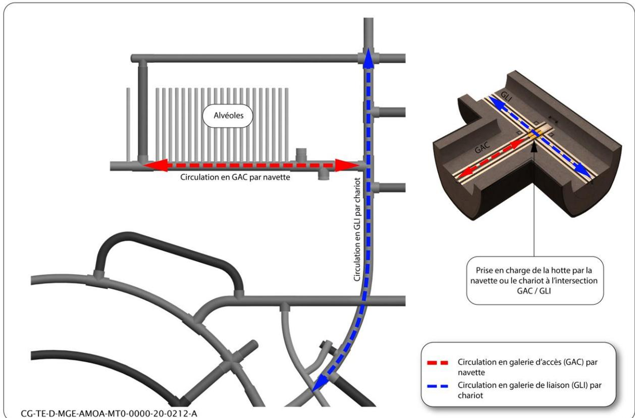
Figure 4-18 Illustration de la circulation des hottes HA jusqu'aux alvéoles
