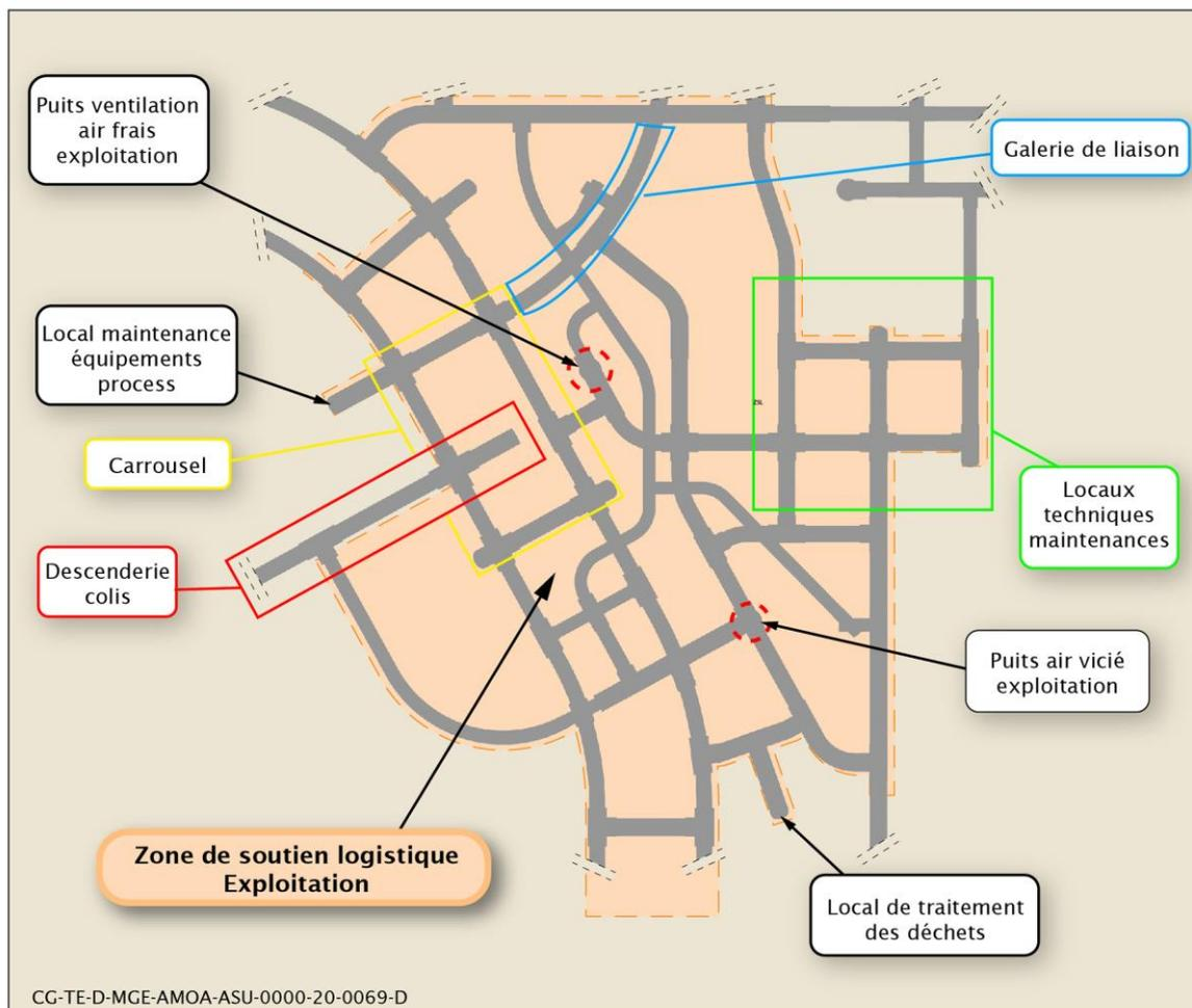
Figure 3-15 Illustration de la zone de soutien logistique d'exploitation
