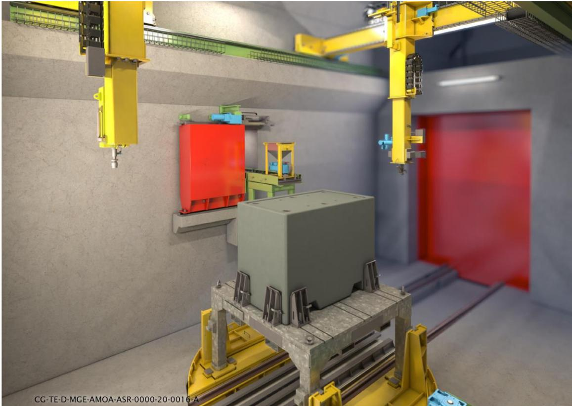
Figure 4-8 *Illustration de la cellule de fermeture des colis de stockage MA-VL*
