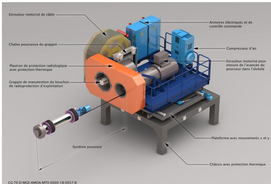
Figure 4-24 Illustration du robot pousseur des colis de stockage HA
