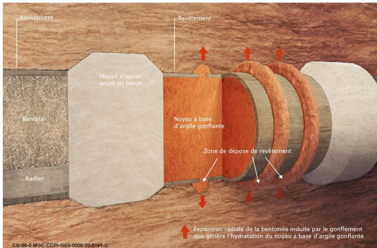
Figure 3-21 Exemple illustratif d'un scellement de galerie et du remblai de galerie
