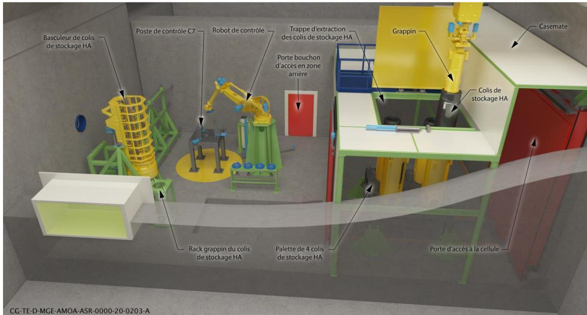
Figure 4-11 Illustration de la cellule de mise en hotte des colis de stockage HA
