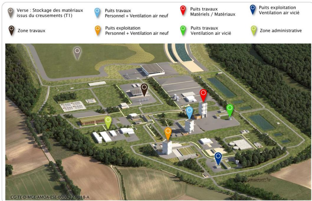
Figure 2-6 Vue de principe de la zone puits
