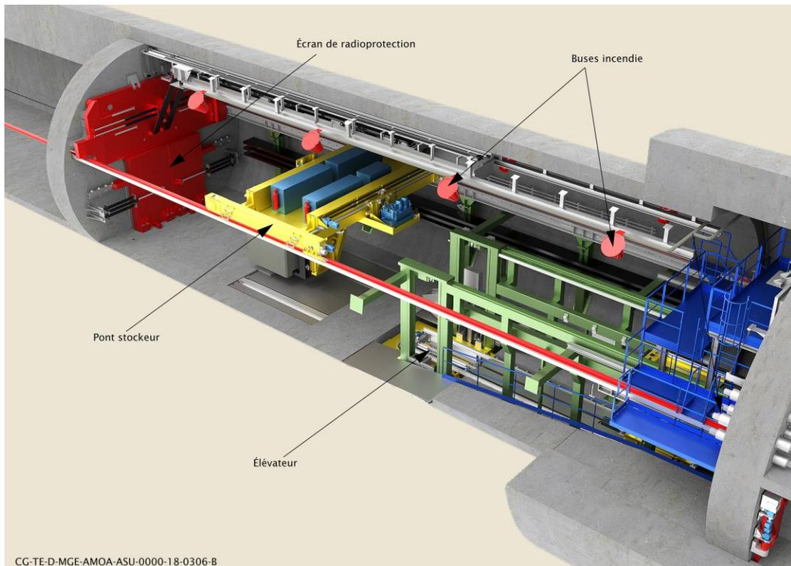
Figure 4-21 *Illustration de la cellule et des équipements de manutention de l'alvéole de stockage MA-VL*
