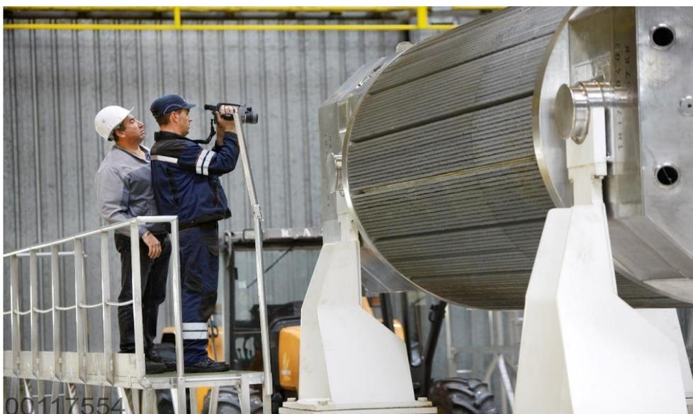
Figure 4-2 Photographie d'un exemple d'opérations de contrôle visuel d'un emballage de transport
