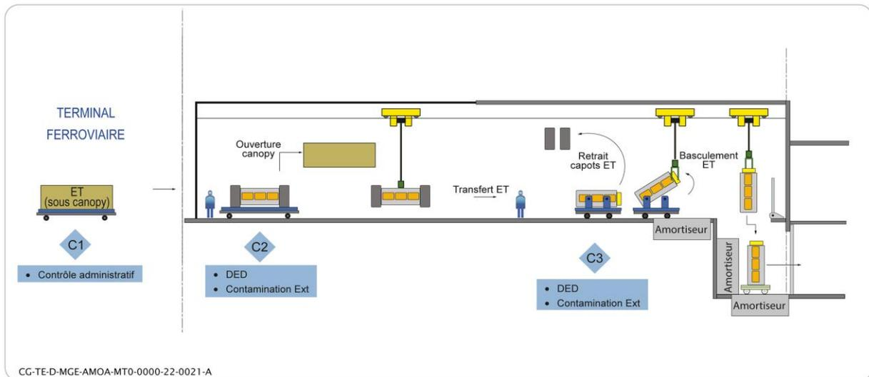
Figure 4-4 Illustration des étapes de réception et de basculement des emballages de transport à déchargement vertical
