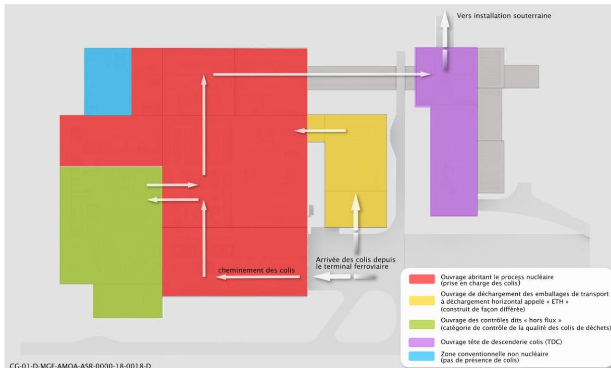
Figure 3-2 Principe d'organisation spatiale du bâtiment nucléaire de surface EP1 et de la tête de descenderie colis
