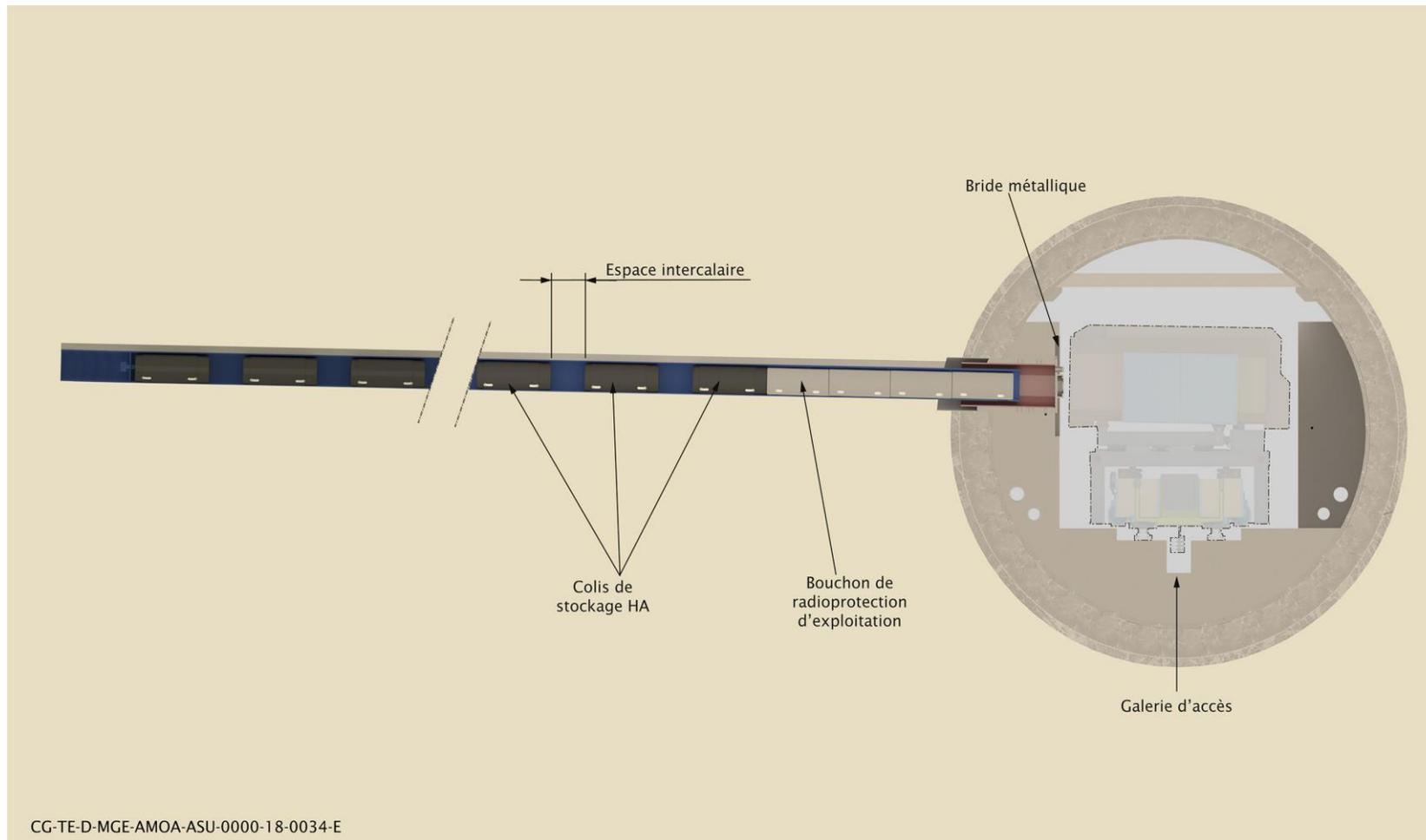
Figure 3-19 Coupe longitudinale schématique d'un alvéole HA (espace respecté entre les colis de stockage)
