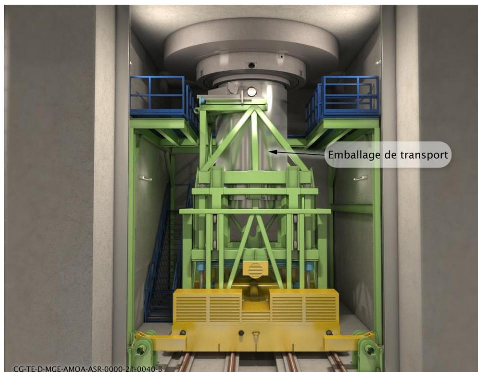
Figure 4-5 Illustration d'un emballage de transport sur son chariot au poste d'accostage vers la cellule de déchargement des colis primaires
