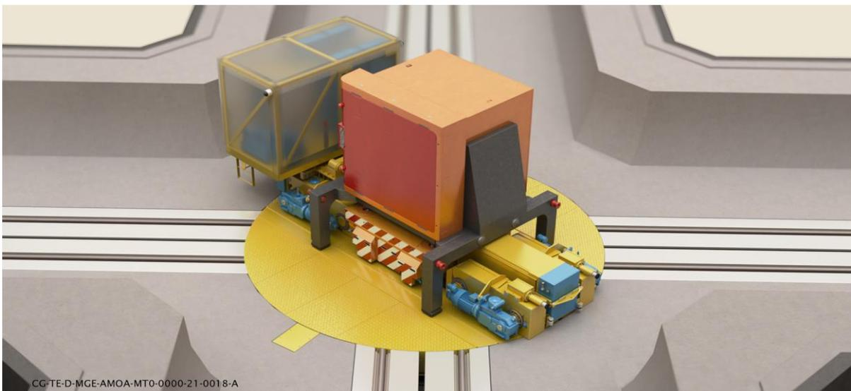
Figure 4-16 Illustration d'une table tournante au niveau d'un carrousel
