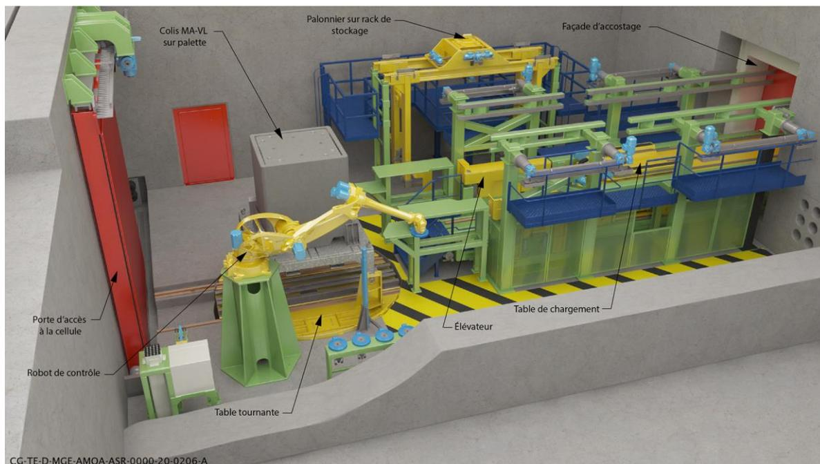
Figure 4-10 Illustration de la cellule de mise en hotte MA-VL
