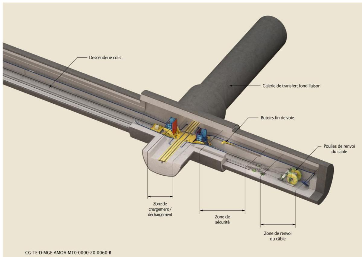
Figure 3-11 Illustration du funiculaire stationné au niveau de la gare basse de la descenderie colis
