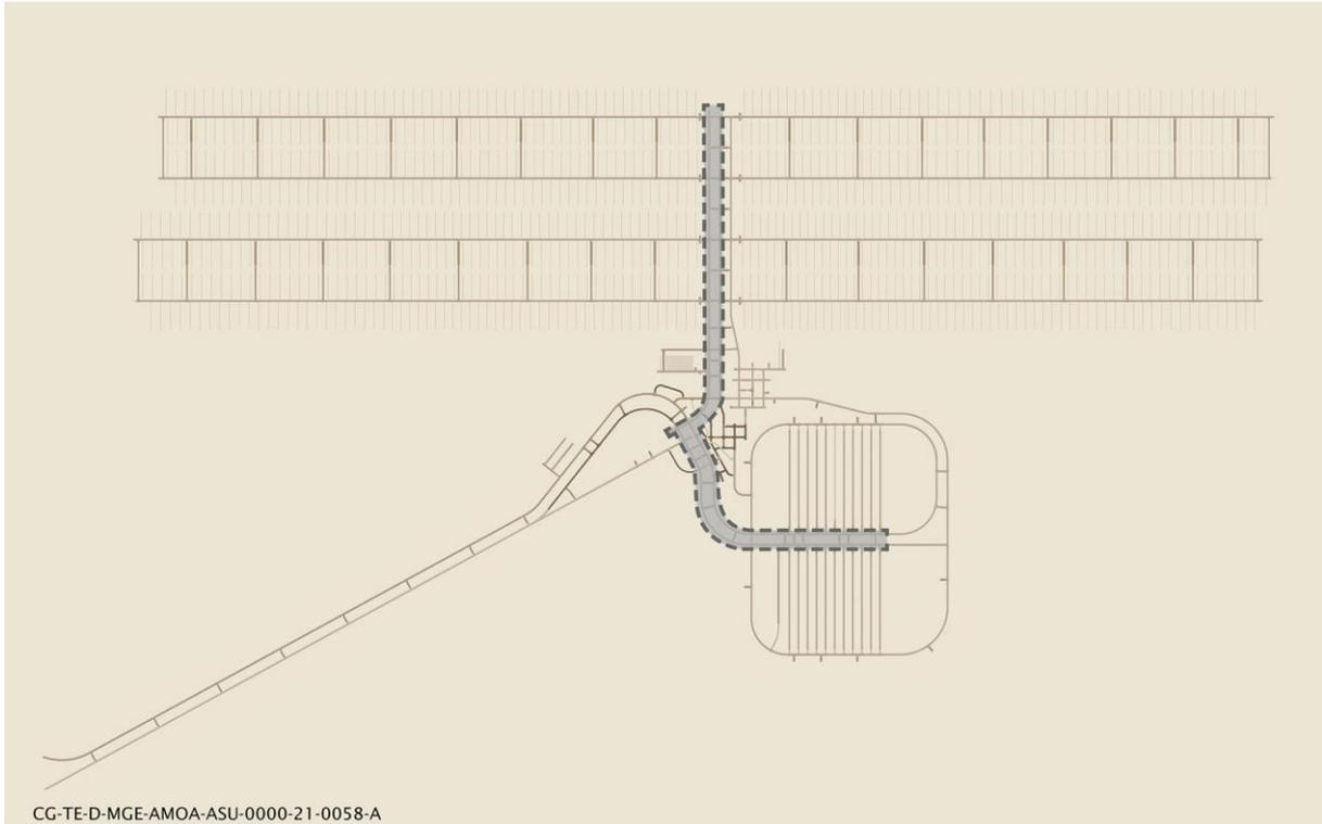
Figure 4-15 Illustration de la localisation des galeries de liaison HA et MA-VL
