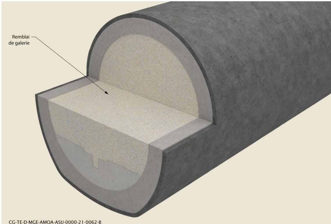
Figure 3-20 Illustration d'une galerie souterraine remblayée
