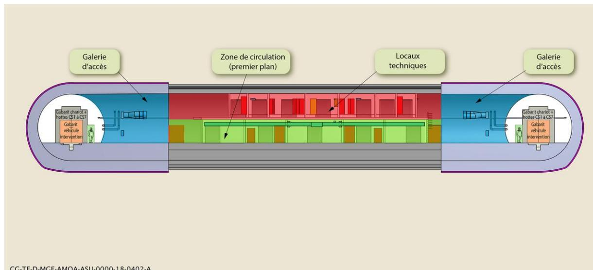
Figure 3-16 Schéma de principe de la recoupe et de l'évacuation/secours entre les galeries de liaison
