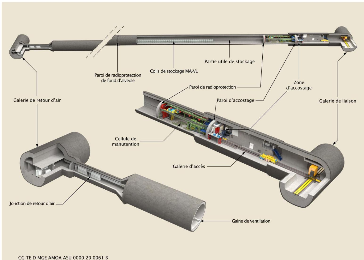
Figure 3-17 Illustration de la constitution d'un alvéole MA-VL
