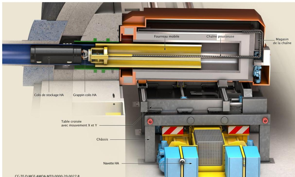
Figure 4-25 Illustration du transfert du colis de stockage HA dans l'alvéole
