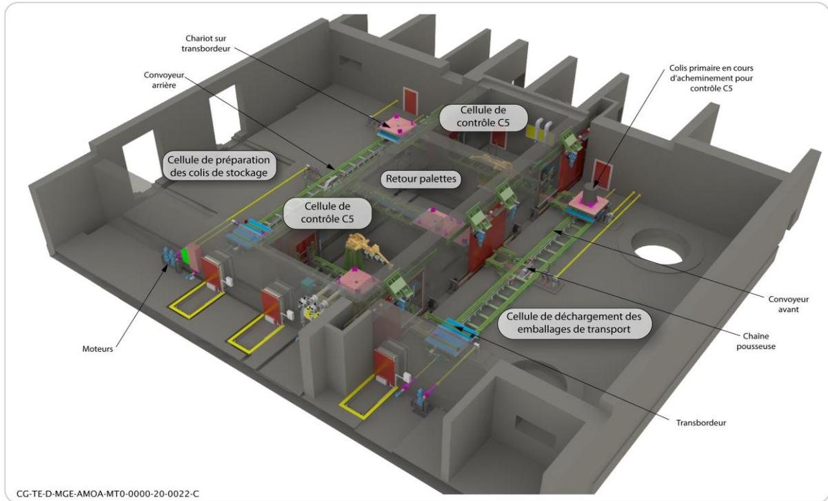
Figure 4-6 Illustration du système de transfert des colis primaires
