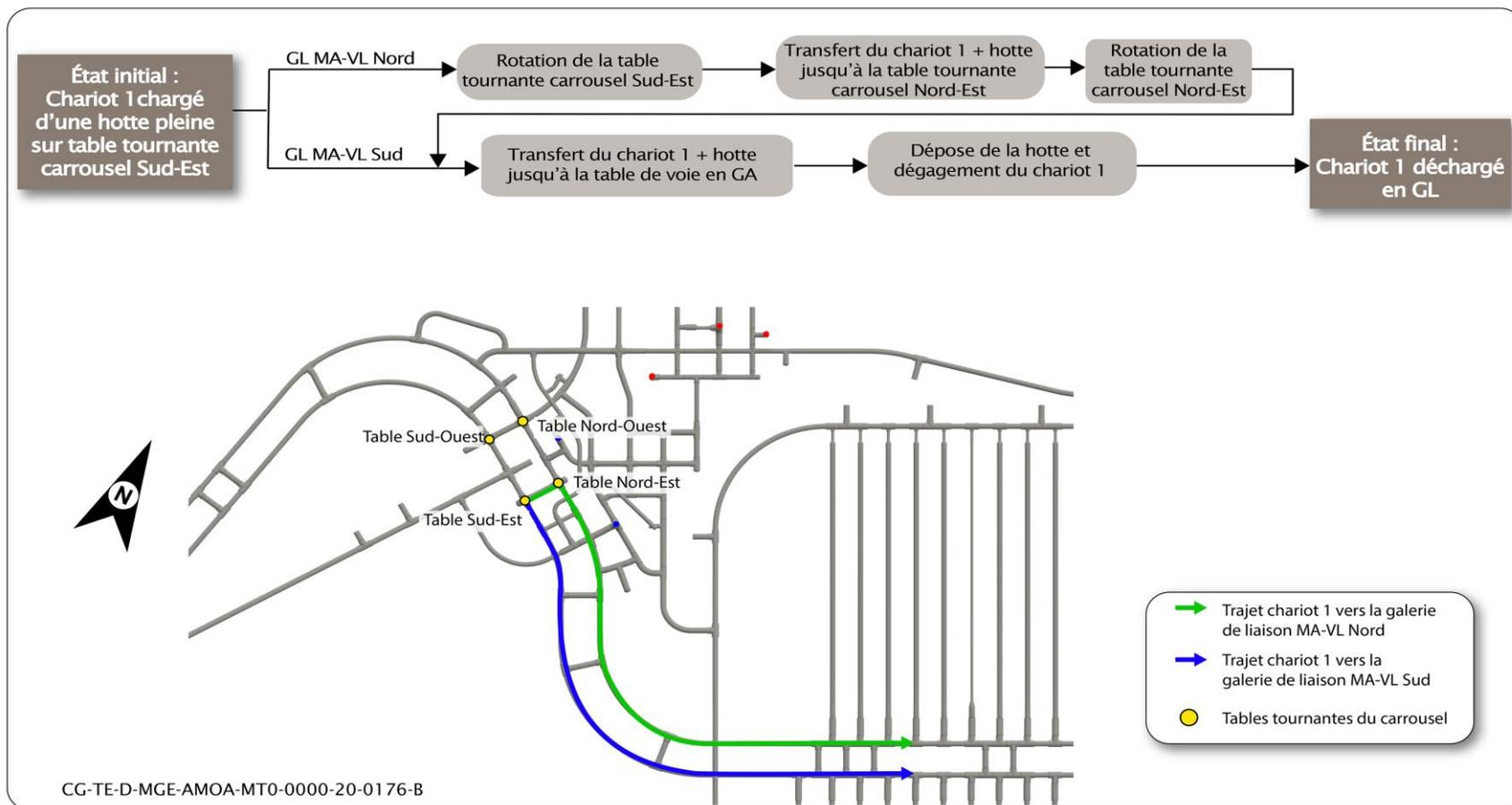
Figure 4-17 Illustration de la circulation des équipements de manutention des hottes MA-VL
