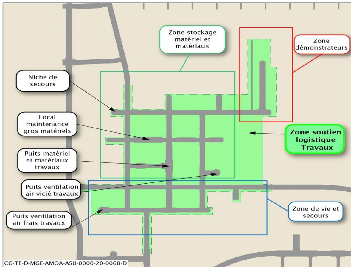
Figure 3-14 Illustration de la zone de soutien logistique travaux
