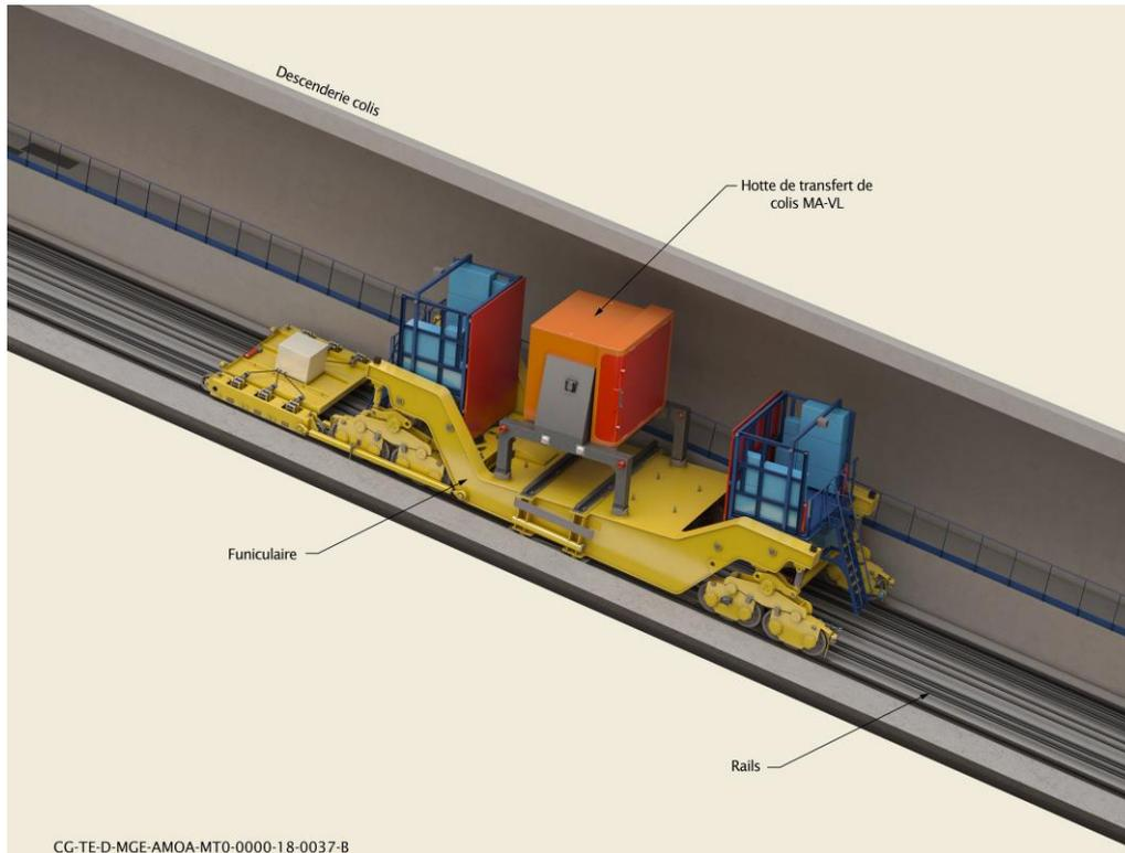
Figure 4-14 *Illustration du funiculaire transportant une hotte MA-VL en cours de transfert dans la descenderie colis*
