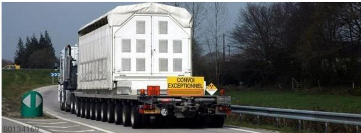
Figure 3-25 Photographie d'un convoi de transport routier de colis de déchets radioactifs
