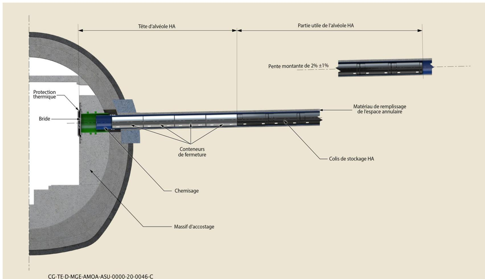
Figure 4-27 Illustration des conteneurs de fermeture mis en place dans l'alvéole HA
