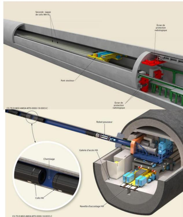
Figure 1-6 Illustrations d'un alvéole MA-VL (à gauche) et d'un alvéole HA (à droite)
