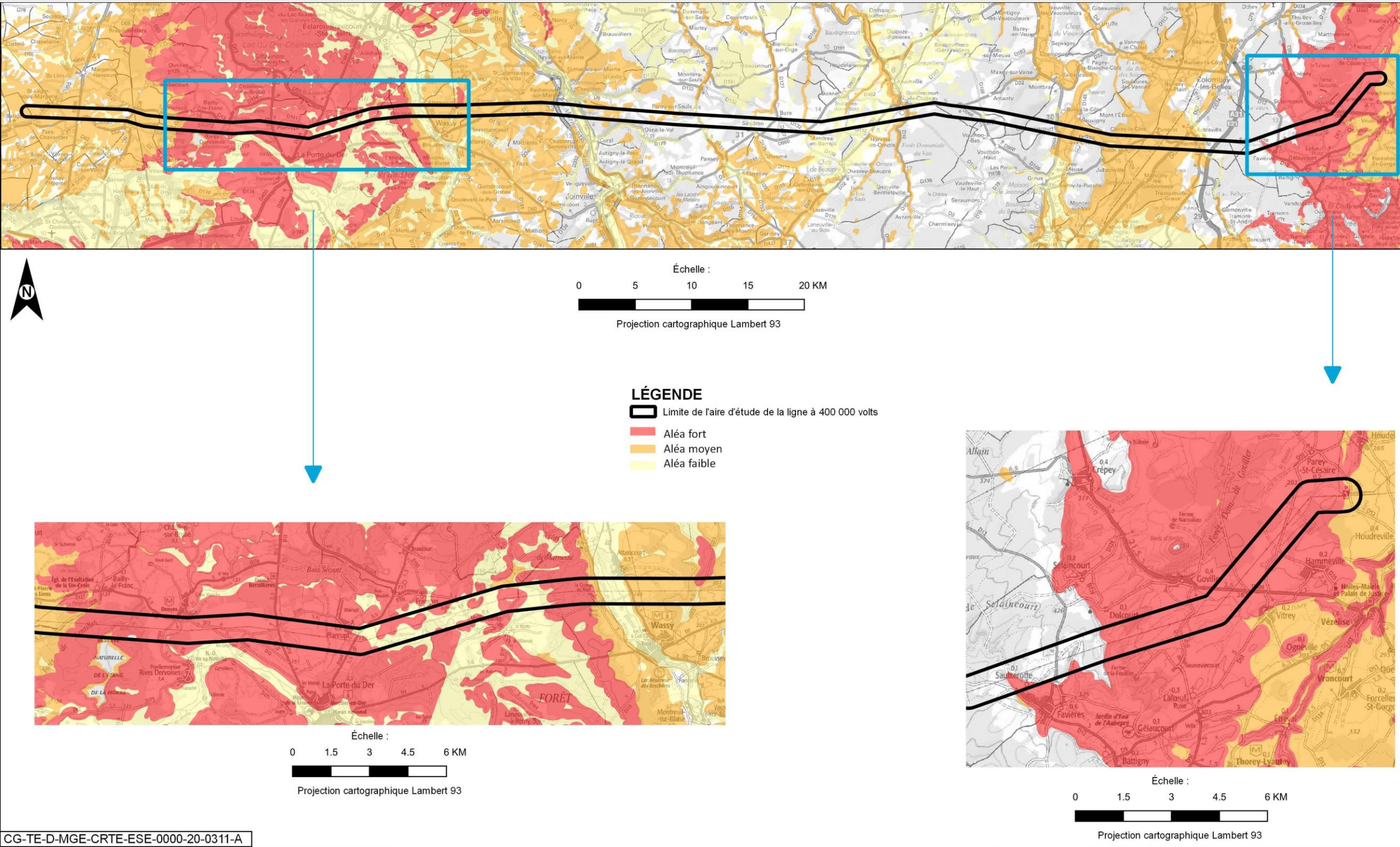
Figure 4-15 Risque lié au retrait/gonflement des argiles le long de la ligne électrique 400 kV
