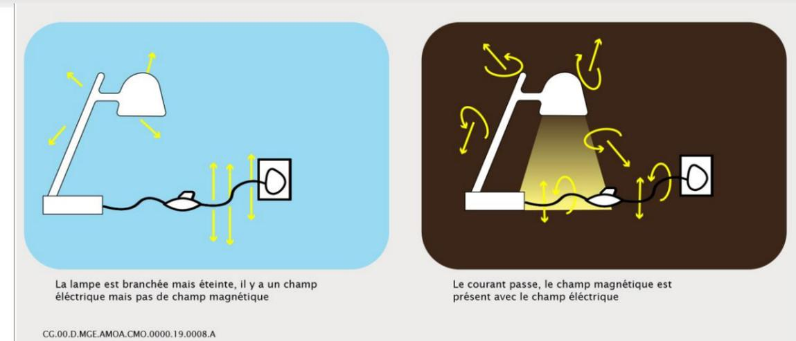
Figure 13-11 Illustration des champs électriques et magnétiques
