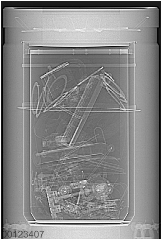
Figure 4-1 Photographie d'une radiographie très haute énergie d'un colis contenant un fût de déchets technologiques placé dans un conteneur en béton
