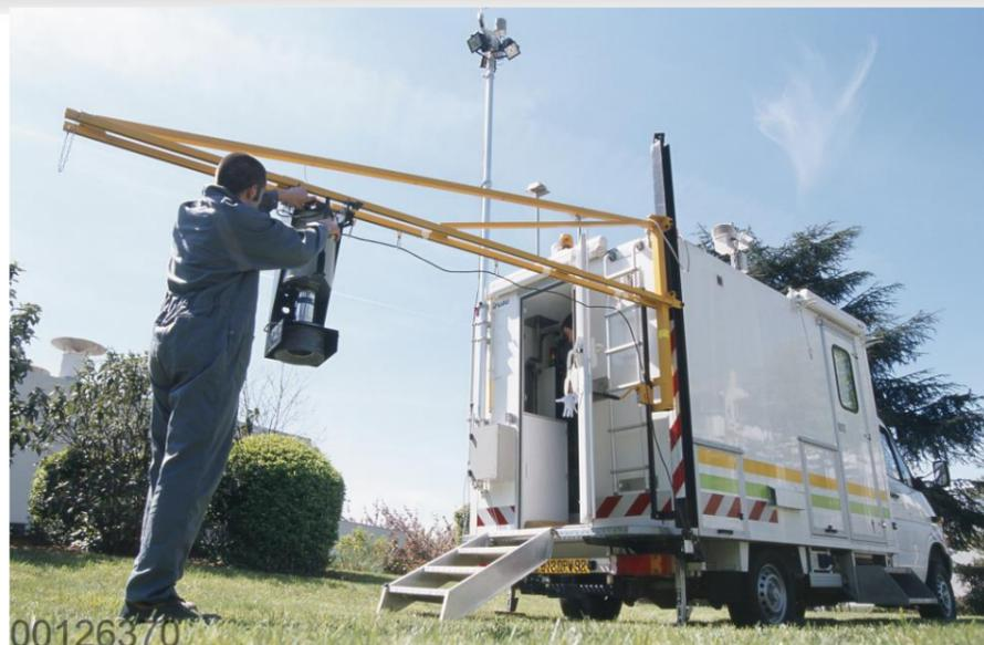
Figure 18-10 Illustration de dispositif de cartographie radiologique
