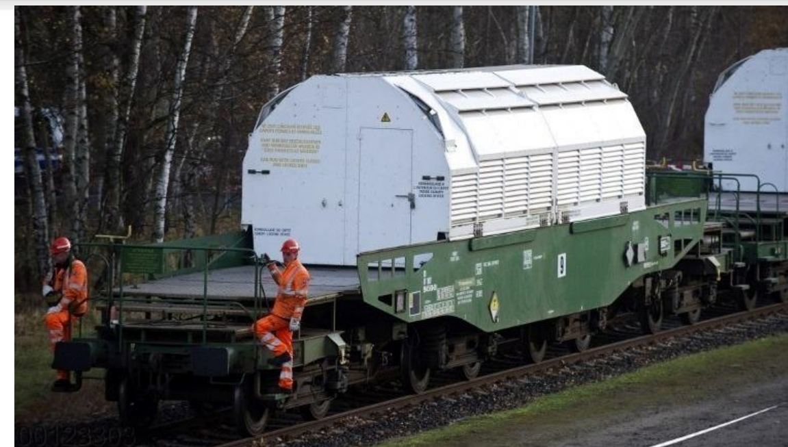
Figure 4-8 Photographie d'emballages de transport de déchets radioactifs sur un train
