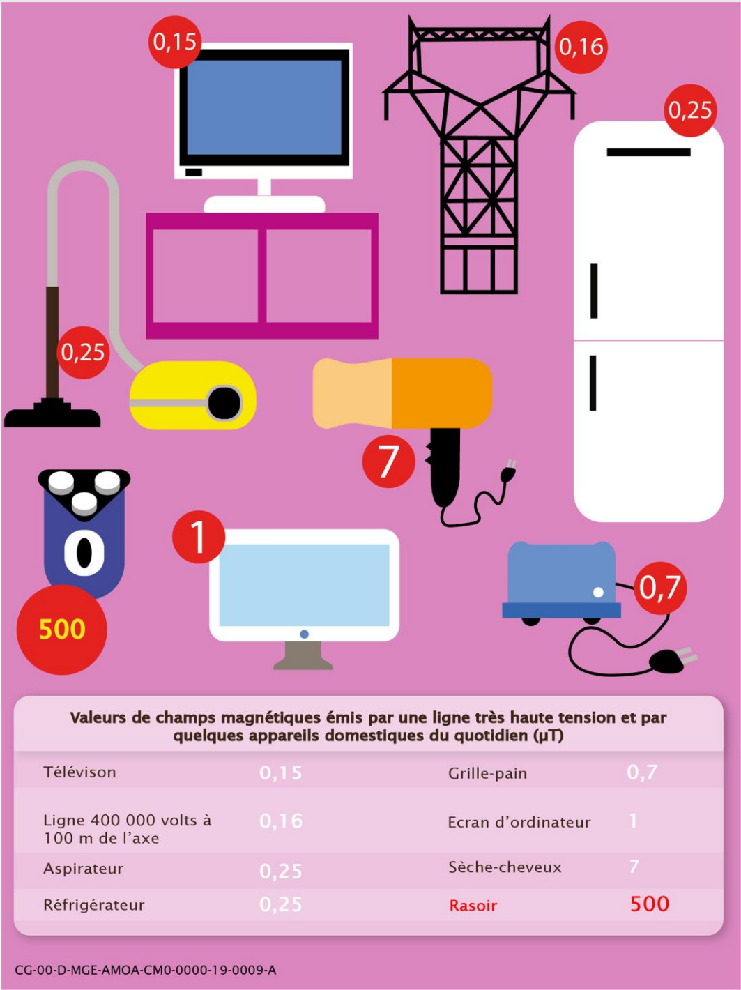
Figure 2-8 Champs électromagnétiques émis par des appareils et installations de la vie quotidienne
