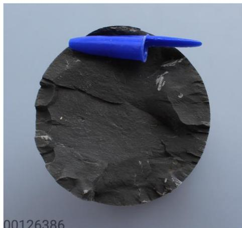
Figure 1-21 Photographie d'un échantillon d'argilite du Callovo-Oxfordien prélevé dans un forage du Laboratoire de recherche souterrain de Meuse/Haute-Marne (unité argileuse UA)
