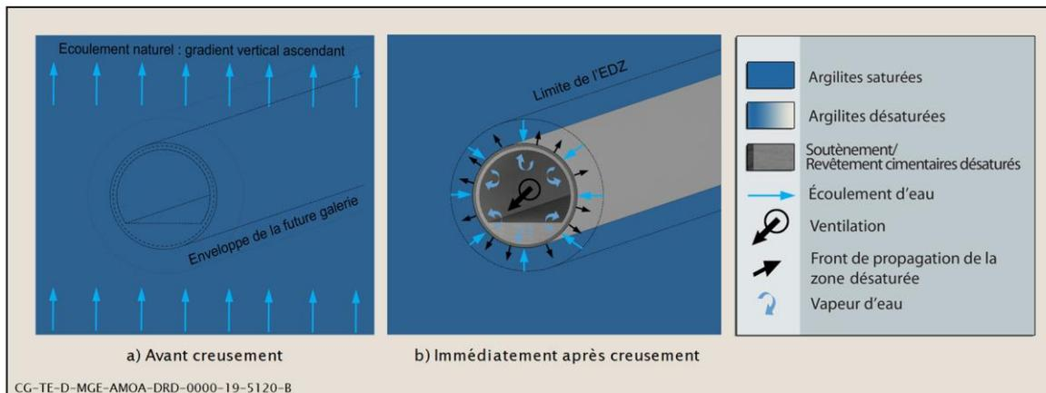
Figure 3-7 Illustration des écoulements d'eau dans le Callovo-Oxfordien avant et après la création des ouvrages
