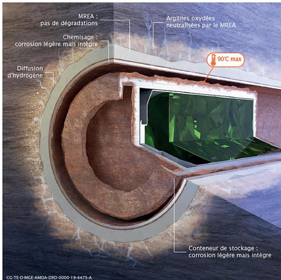
Figure 3-14 Représentation schématique de l'alvéole HA avant la rupture du conteneur de stockage
