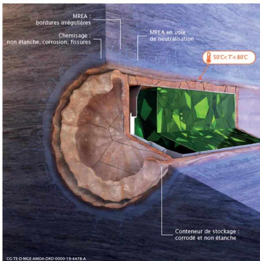
Figure 3-15 Représentation schématique de l'alvéole HA après perte d'étanchéité du conteneur
