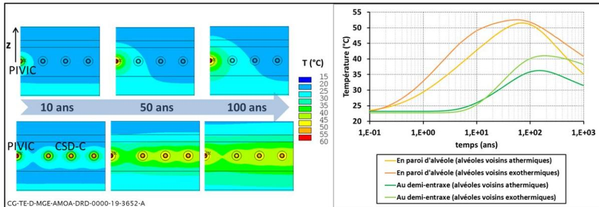
Figure 3-5 Distribution et évolution temporelle des températures autour de l'alvéole de stockage de colis PIVIC en fonction de la présence ou non d'autres colis exothermiques dans les alvéoles voisines
