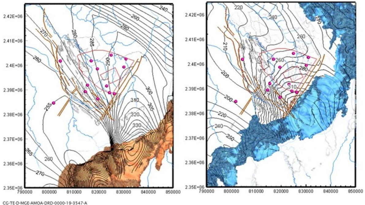
Figure 2-3 Champs des écoulements observés dans les formations du Dogger (à gauche) et de l'Oxfordien carbonaté (à droite)
