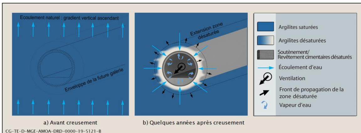
Figure 3-8 Illustration schématique de la désaturation autour des ouvrages ventilés
