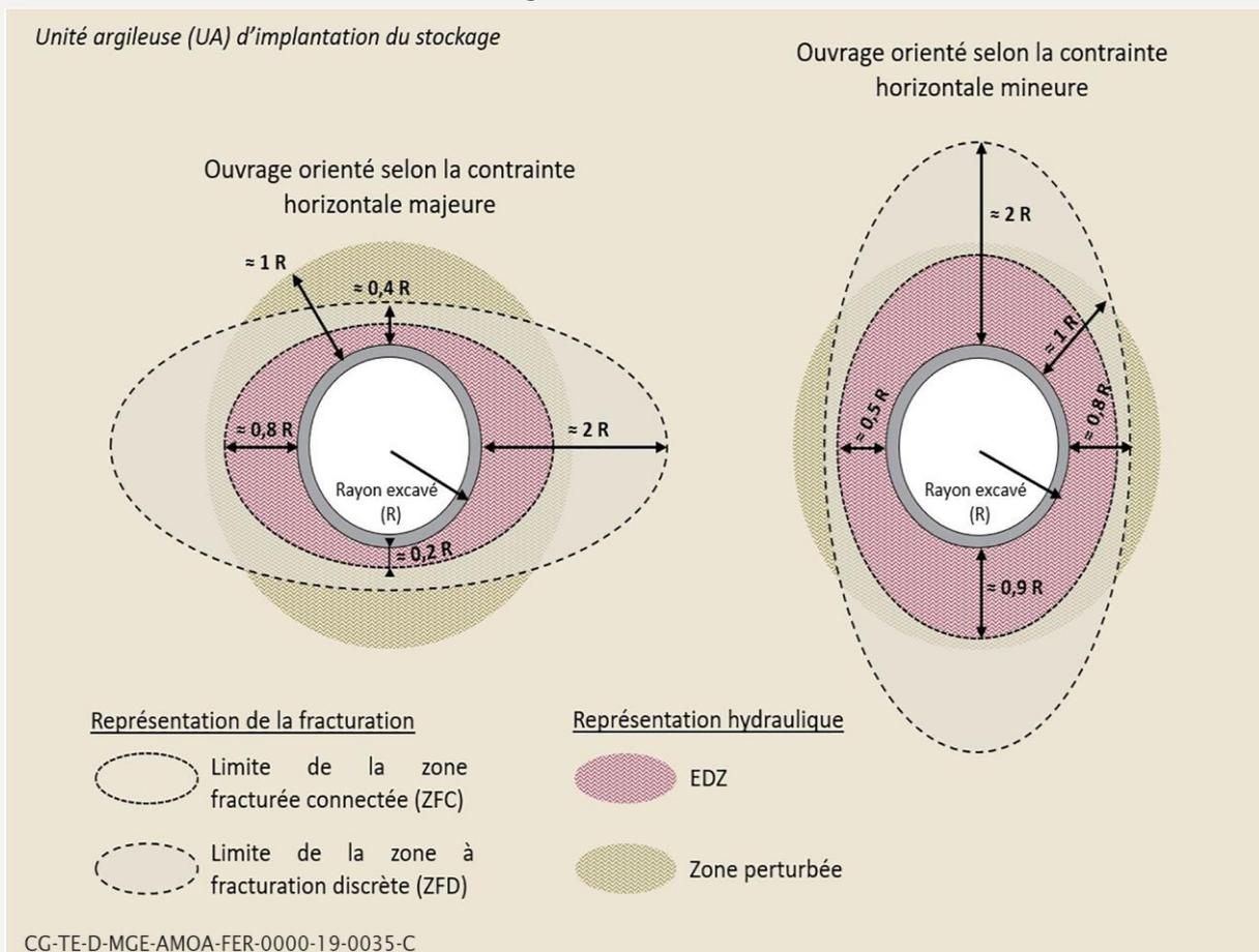
Figure 3-18 Représentation schématique de la zone endommagée autour des ouvrages dans l'unité argileuse du Callovo-Oxfordien
