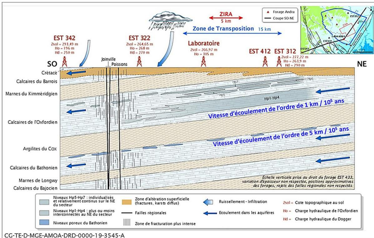
Figure 2-2 Fonctionnement hydrogéologique du système aquifère multicouche à l'échelle du secteur de Meuse/Haute-Marne
