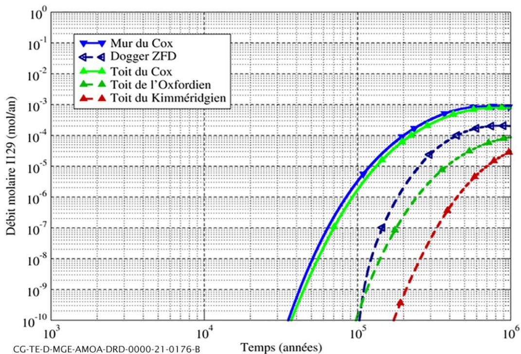
Figure 4-11 Historiques de débit molaire en iode 129 dans le milieu géologique : toit et mur du Callovo-Oxfordien, toits de l'Oxfordien et du Kimméridgien, dans le Dogger (dans la zone de fracturation diffuse)
