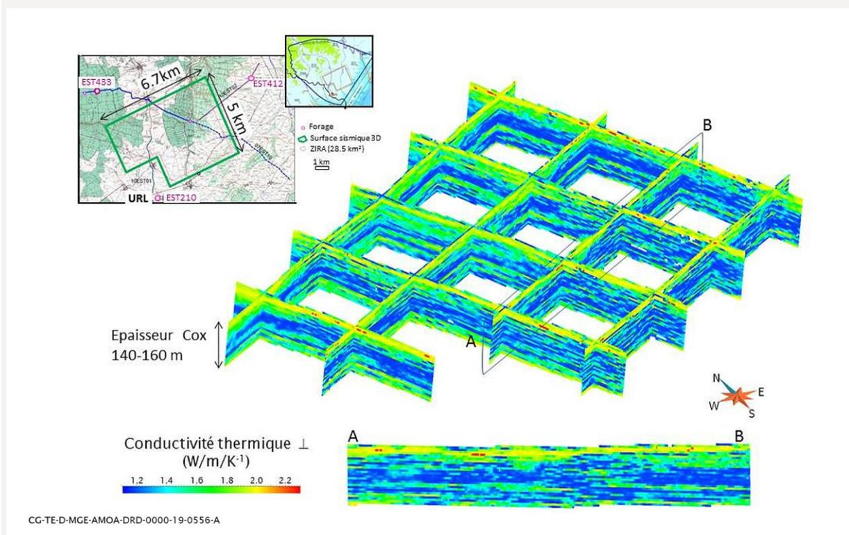
Figure 3-1 Distribution spatiale de la conductivité thermique moyenne perpendiculaire à la stratification à l'échelle de la ZIOS
