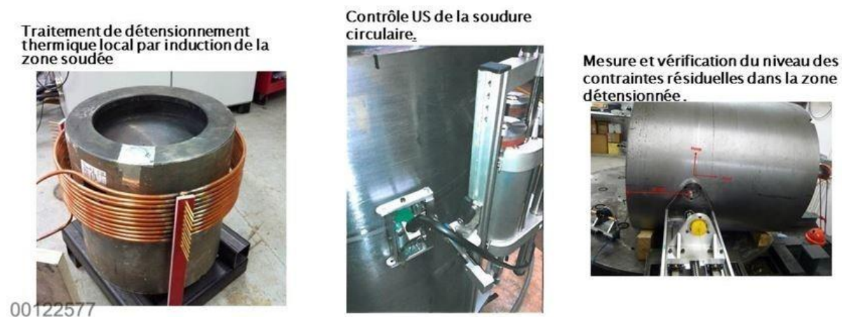
Figure 2-5 Traitement de détensionnement thermique (photo 1) et tests de vérification de la qualité des soudures sur conteneurs HA (photos 2 et 3)
