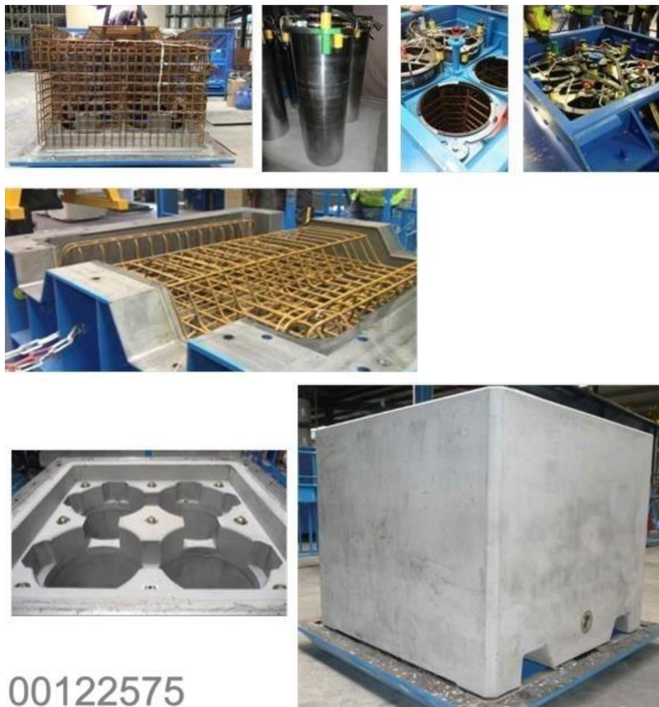
Figure 2-12 Illustration des étapes de fabrication de prototypes CS 3, CS 2 et CS 4
