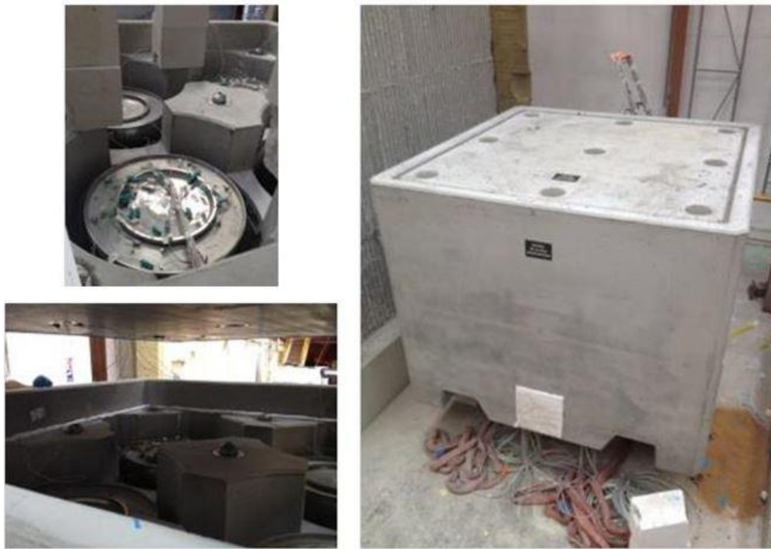
Conteneur CS4 - après essai (feu ISO 834 pendant 1h)
