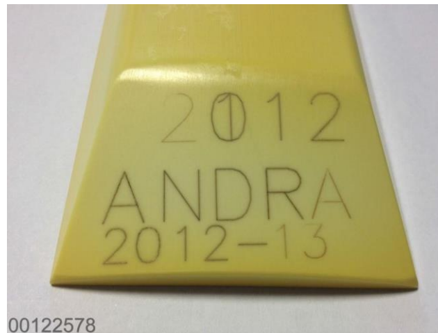
Figure 2-3 Exemple de marquage par gravure sur un patin en céramique
