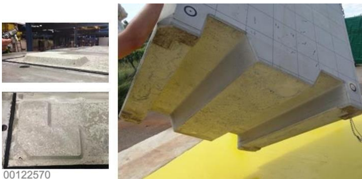
Figure 2-8 Pieds des conteneurs lors du coulage et sur un prototype échelle 1
