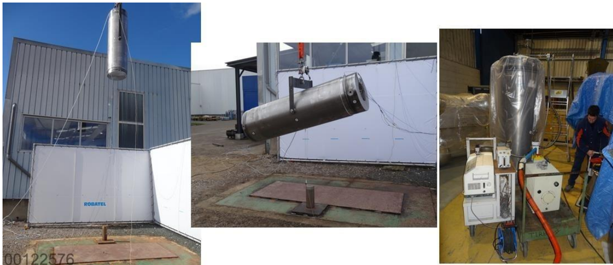
Figure 2-4 Essais de chute et tests de vérification d'étanchéité à l'hélium associés
