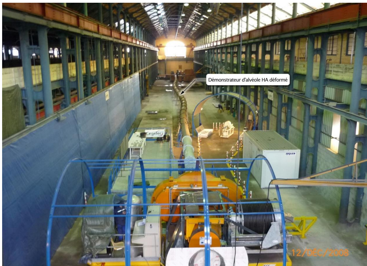
Figure 2-26 Test de mise en place et de récupérabilité sur 100 mètres de longueur d'un colis HA dans un alvéole fortement déformé, à l'aide du « robot ESDRED »
