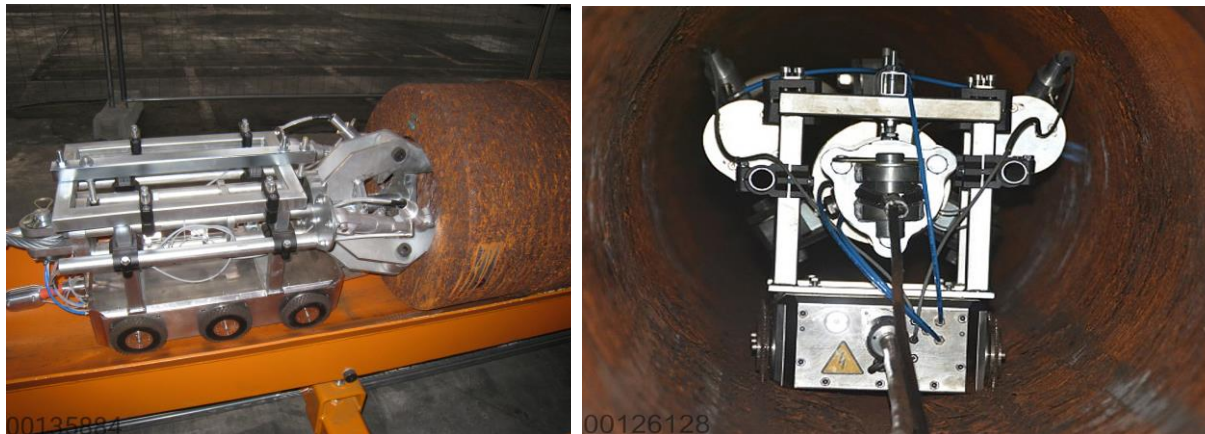
Figure 2-29 Robot de retrait en alvéole HA
