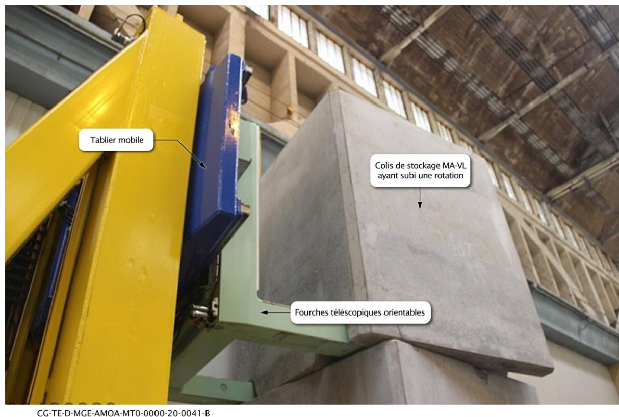
Figure 2-25 Test de récupération d'un colis MA-VL désaxé sur sa pile
