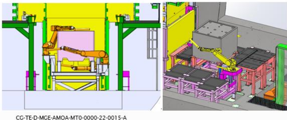
Figure 4-9 Schéma de principe du dispositif de contrôle de la contamination en cellule de manutention (colis MA-VL stocké en nappe niveau 1 de la partie active)
