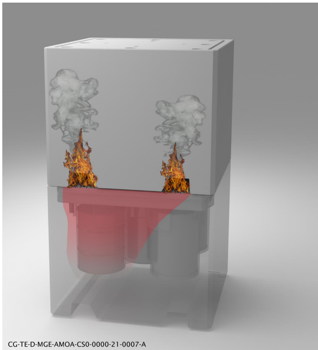
Figure 5-29 Illustration de la situation accidentelle sévère d'inflammation d'un fût de déchets bitumés dans un colis de stockage
