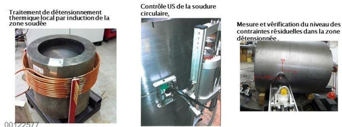
Figure 3-5 Photographies d'essais réalisés sur des démonstrateurs de conteneurs de stockage HA
