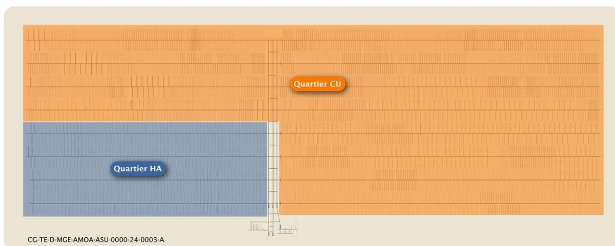
Figure 7-2 *Illustration des quartiers de stockage HA et de CU (hypothèse à terminaison pour le scénario dit « SNR » enveloppe des évolutions de politique énergétique de l'Inventaire national (27))*
