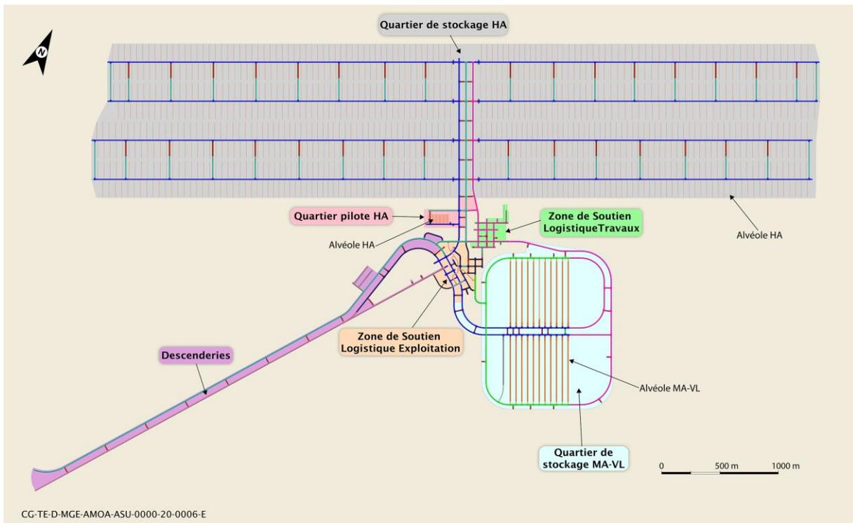
Figure Annexe 1-4 Schéma illustratif de l'organisation spatiale des ouvrages de la ZIOS (vue en surplomb – les puits verticaux ne sont donc pas visibles)
