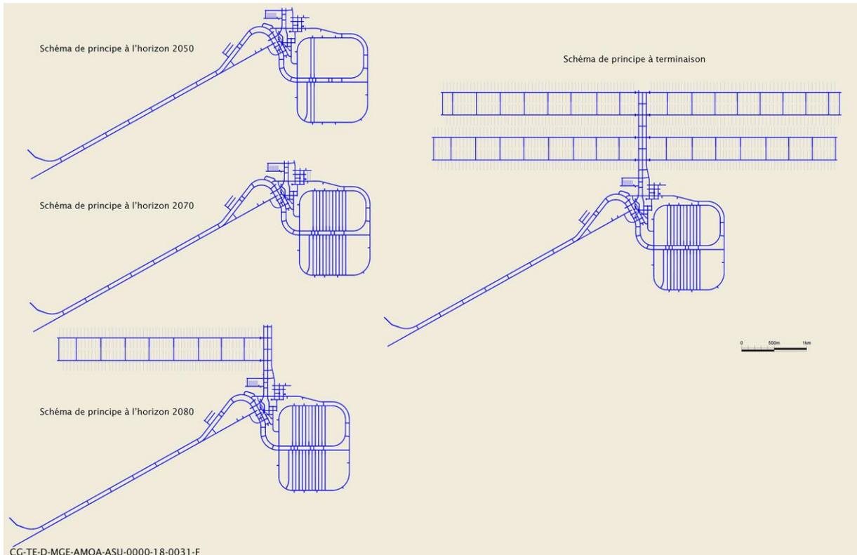
Figure 5-7 Schéma illustratif du déploiement progressif de l'architecture souterraine du centre de stockage Cigéo en phase de fonctionnement
