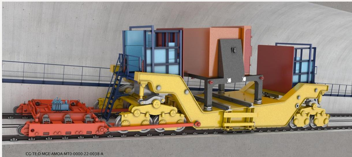
Figure 2-22 *Illustration du véhicule funiculaire chargé d'une hotte MA-VL*
