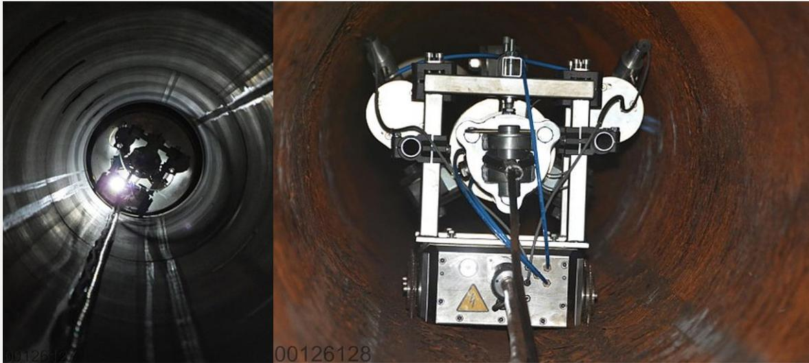
Figure 2-35 Photographies du robot de retrait d'un colis de stockage HA en alvéole HA
