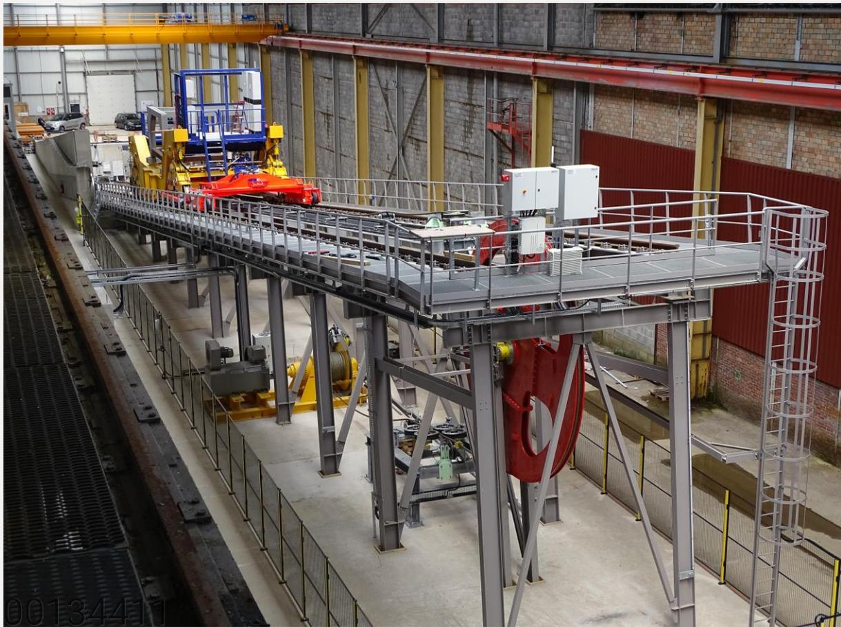
Figure 2-23 Photographie du banc d'essai du système de freinage du funiculaire
