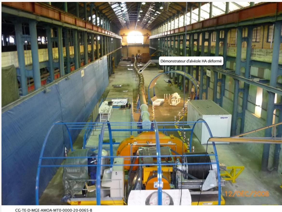
Figure 2-34 Photographie du test de mise en place et de récupérabilité sur 100 mètres de longueur d'un colis HA dans un alvéole fortement déformé, à l'aide du « robot ESDRED »
