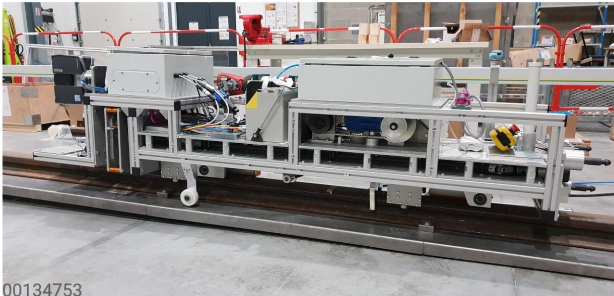
Figure 2-42 Photographie d'un exemple de robot d'inspection sur rail pour alvéole MA-VL
