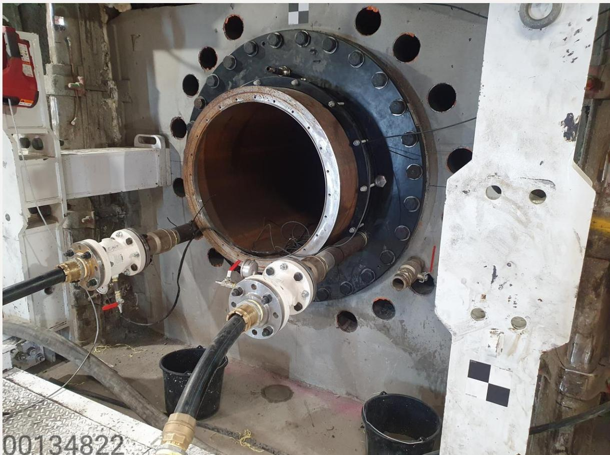
Figure 2-33 *Tête de l'essai d'alvéole HA AHA1631 réalisé au Laboratoire de recherche souterrain de Meuse/Haute-Marne*
