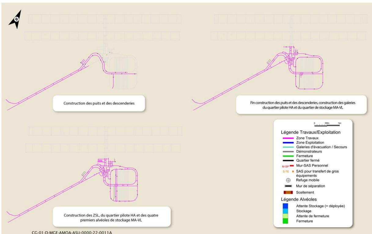
Figure 2-16 Illustration du déploiement temporel de la première tranche de l'installation souterraine au cours de la phase industrielle pilote
