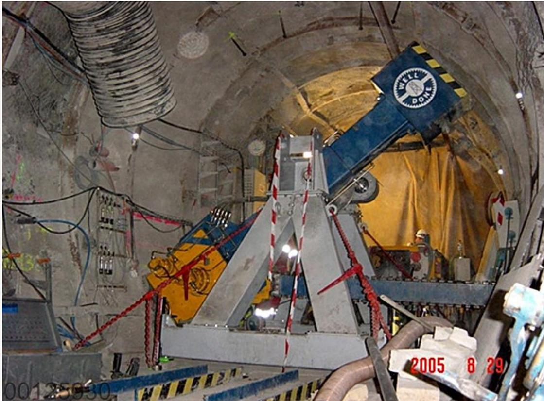
Figure 4-5 Photographie de l'essai Key de réalisation d'une saignée réalisé dans le Laboratoire de recherche souterrain de Meuse/Haute-Marne
