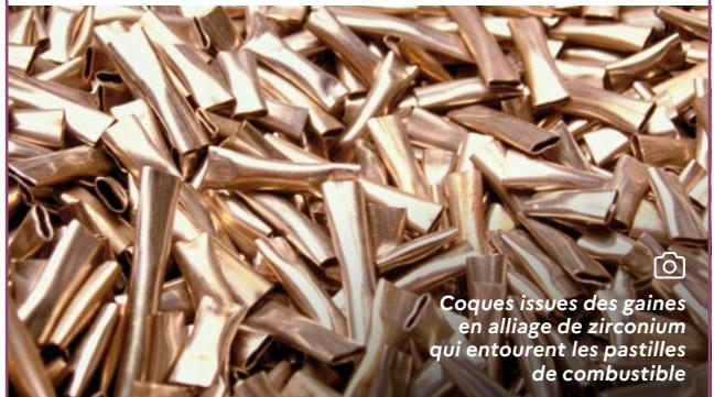
Coques issues des gaines en alliage de zirconium qui entourent les pastilles de combustible
