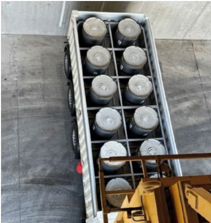
↓ Déchargement de déchets FMA en cours à l'entrée d'un ouvrage de stockage
