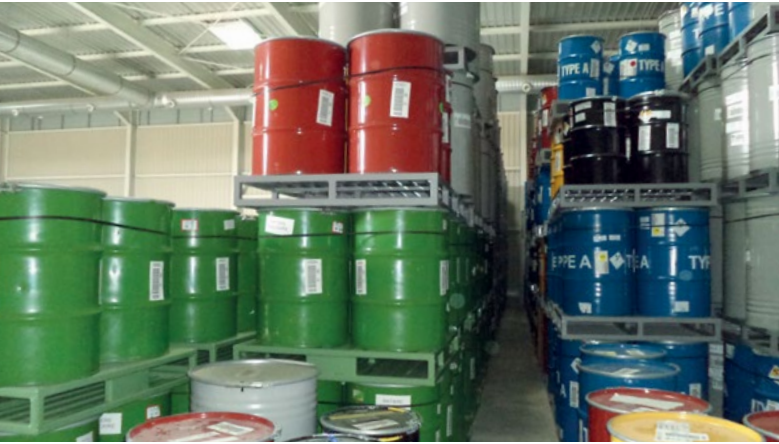
↑ Les colis de déchets FA-VL sont entreposés dans un bâtiment du Cires dédié, en attente d'une filière de stockage.
