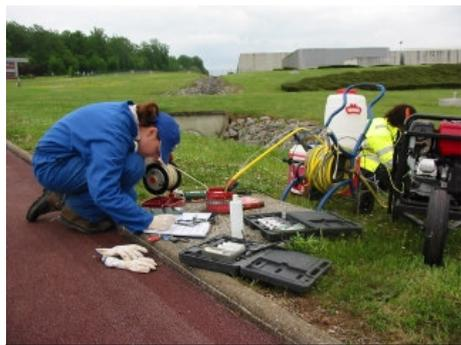
Figure 13 : opération de pompage sur le piézomètre DS24
