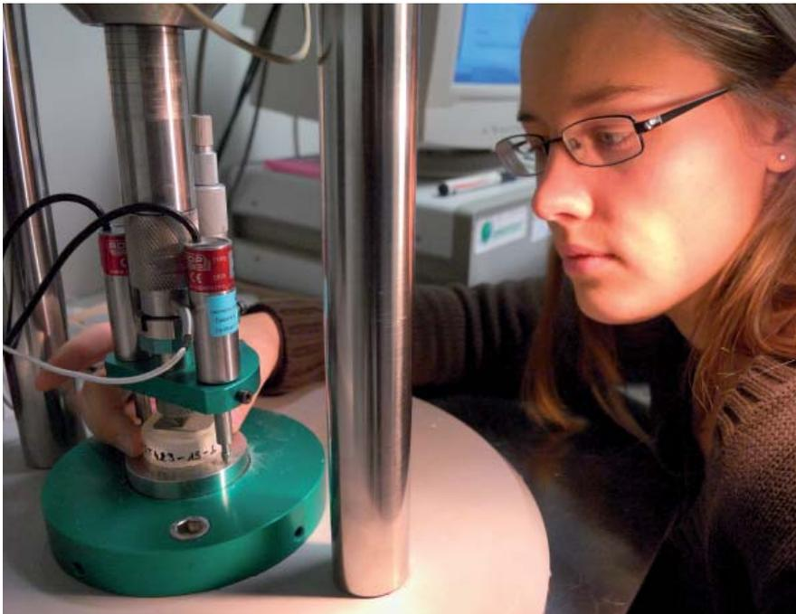
02. Essai de contrainte mécanique sur un échantillon d'argile
