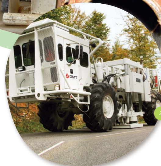
1 _Forage et captation d'eau autour du Laboratoire souterrain. 2 _Camion vibreur.
