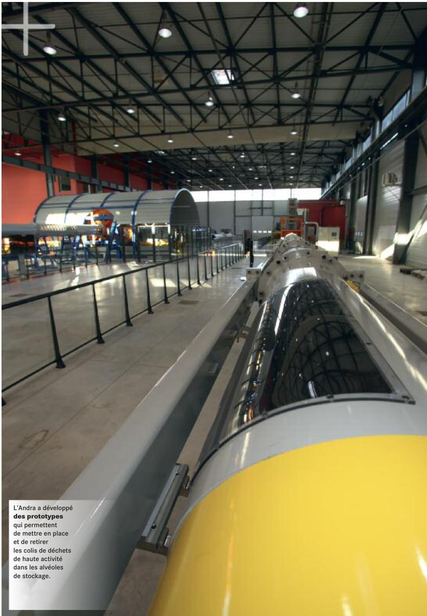
L'Andra a développé **des prototypes** qui permettent de mettre en place et de retirer les colis de déchets de haute activité dans les alvéoles de stockage.
