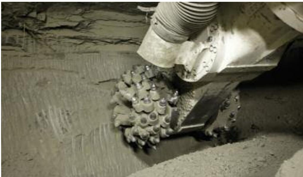
— La machine à attaque ponctuelle, avec sa tête de forage particulière, permet de tester une nouvelle méthode de creusement.
