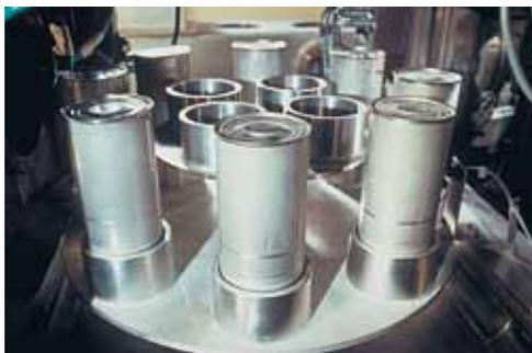
*Carrusel des boîtes de plutonium à l'usine de fabrication de combustible MOX Melox d'AREVA à Marcoule (30)*
