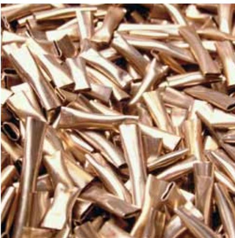
Déchets de structure du combustible usé avant conditionnement (MA-VL)
