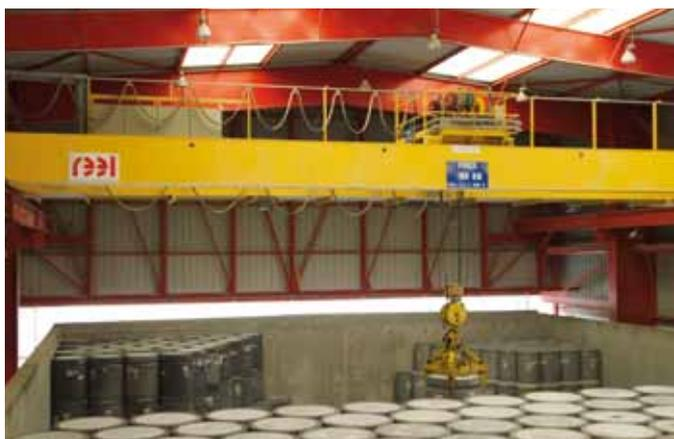
Dépôt d'une coque béton dans un alvéole
