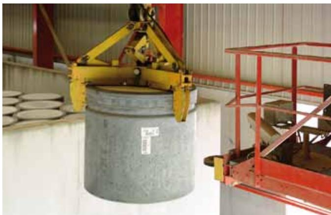
Fût de déchets cimentés et coques bétons de déchets cimentés
