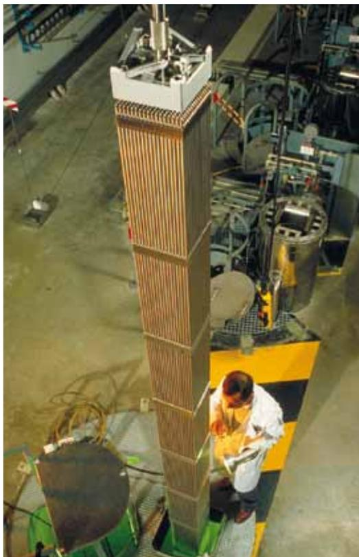
*Contrôle d'aspect des assemblages combustibles UOX (AREVA)*
