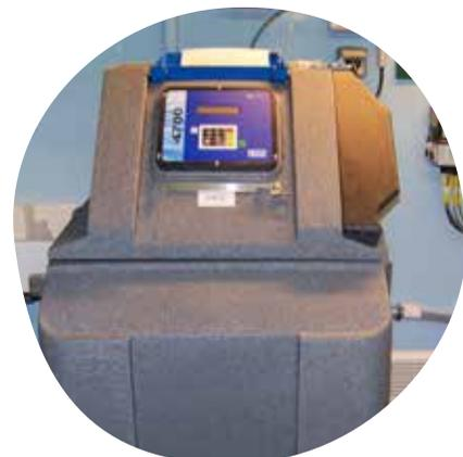
Préleveur réfrigéré ISCO 4700 du réseau pluvial
