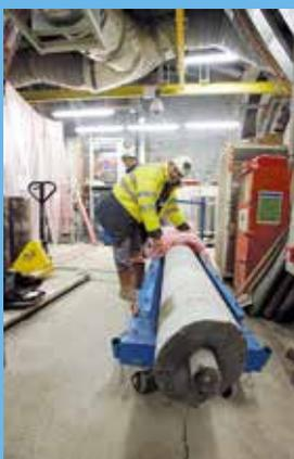
Fin 2015, l'Andra a réalisé son 800° forage carotté dans le Laboratoire souterrain. Les carottes extraites, c'est-à-dire des échantillons cylindriques, sont observées par les géologues après leur extraction. Elles sont ensuite conditionnées avant d'être conservées dans la carothèque de
